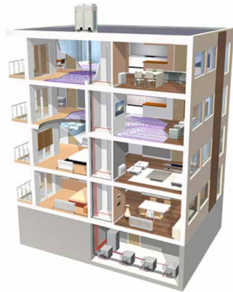
Figura 3.14 Instalación centralizada de calefacción y ACS con bombas de calor en un edificio de viviendas.
