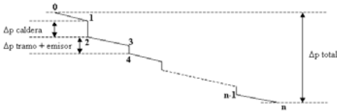
Figura 6.24 Diagrama de la caída de presión en un sistema monotubo.
