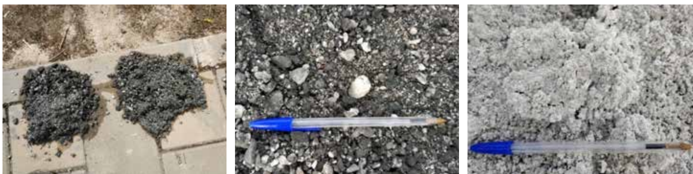
Figura 3.57 En las mediciones en el terreno mediante Test de Respuesta Térmica, es importante además tomar muestra de detritus del pozo para aproximar la columna estratigráfica. Fuente: Eneres.
