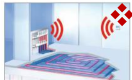
Figura 92. Control del distribuidor del circuito de calefacción a través de un control remoto.
