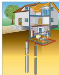
Figura 46. Bomba de calor geotérmica con sondas verticales
