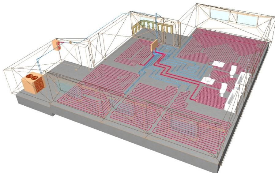
Desde un punto de vista hidráulico las instalaciones de suelo radiante y de radiadores tienen los mismos elementos
