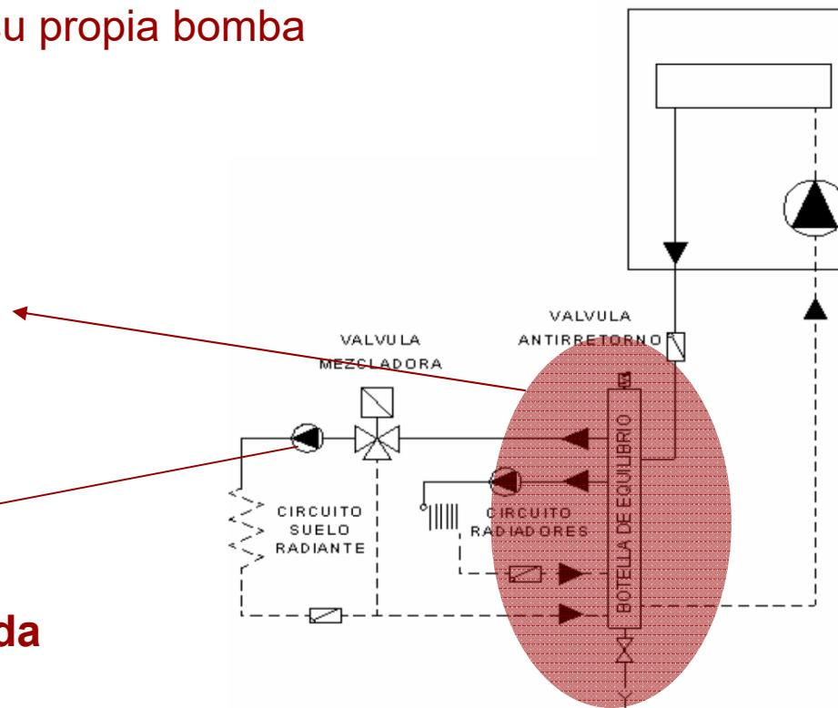
Para el caso de las calderas de gasóleo, después de la entrada en vigor de la ErP, siguen existiendo calderas de baja temperatura. En este caso, siempre será necesaria la instalación de válvulas mezcladoras.
