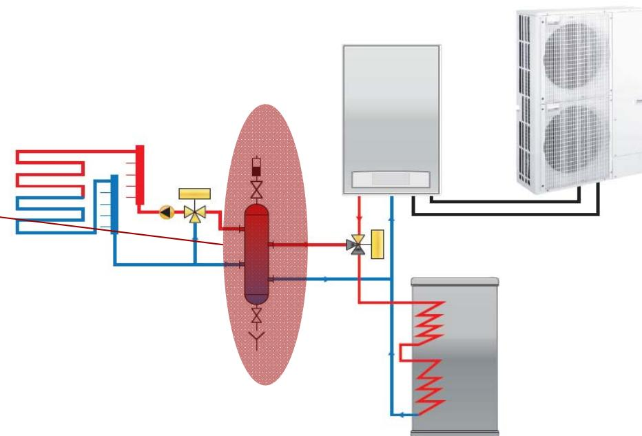
Cuando utilizamos el suelo radiante como sistema de refrigeración en climas con humedades relativas altas, podemos tener problemas con las condensaciones.
