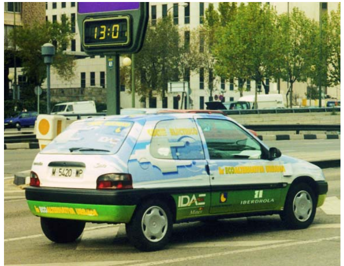
Ejemplo de vehículo eléctrico urbano, con capacidad para dos personas y carga, pensado para la utilización en flotas de servicios de mantenimiento, reparto, mensajería, etc. La velocidad máxima es de 90 km/h, acelera de 0 a 50 km/h en 7 segundos, y tiene una autonomía en ciclo urbano de entre 70 y 100 km. Con un simple enchufe de corriente eléctrica (230 V, 16 A) se puede recargar la batería en unas 7 horas. En algunos países europeos, ya hay estaciones de recarga rápida que permiten recargar, en 10 minutos, la energía necesaria para hacer 30 km.
