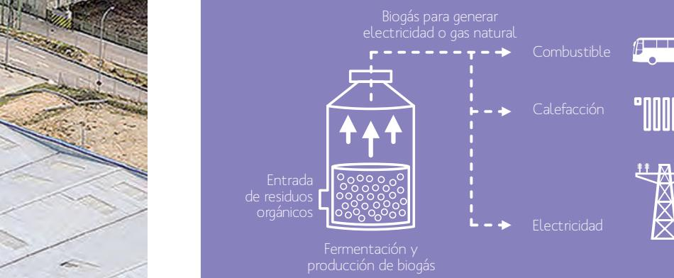
El biogás se recoge y se dirige mediante tuberías a instalaciones de aprovechamiento energético para producir electricidad.
