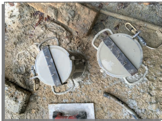
Toma de muestras in-situ de mortero geotérmico.
