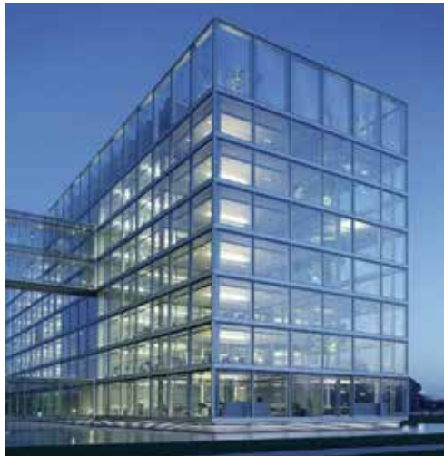
Figura 7.17. Vidrio de control solar neutro. Fuente: Saint-Gobain Building Glass.
