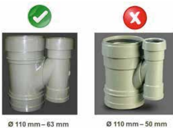
Figura 4.15: Accesorio para ventilación secundaria con diámetro correcto e incorrecto según CTE. Fuente: Nueva Terrain
