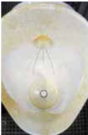
Figura 4.8. Ensayo de funcionamiento del urinario Preda con 0,5 litros recogido en la norma UNE-EN 13407.
