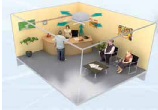
Figura 5.9. Fan-coil de tipo cassette. Fuente: Grupo CIAT
