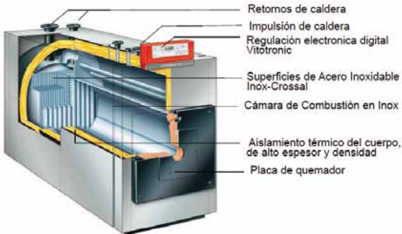
Figura 8.12. Sección de caldera de condensación Vitocrossal 300.
