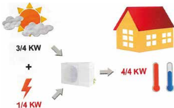
Figura 5.2. Bomba de calor. Fuente: Grupo CIAT.
