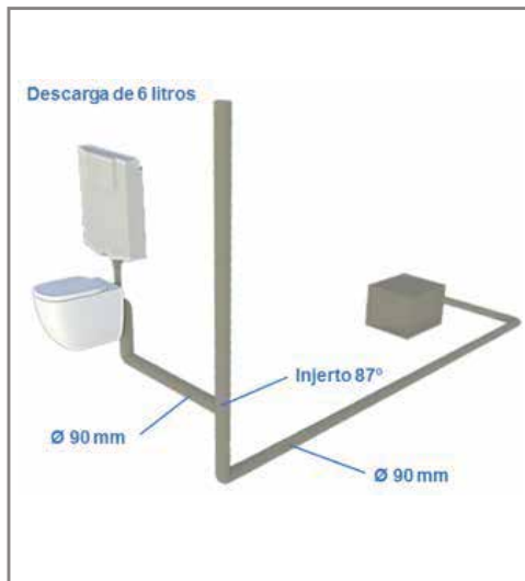
Figura 4.3. Colector con diámetro de 90 mm. Fuente: Geberit.
