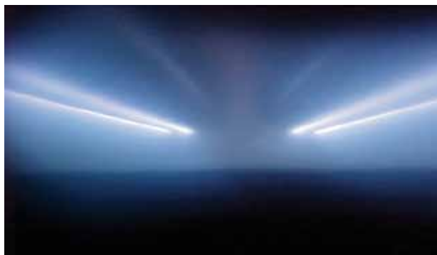
Figura 7.11. Interior de una línea magnetronica. Depósito de la capa sobre el vidrio. Estado de plasma. Fuente: Saint-Gobain Building Glass
