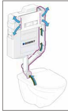
Figura 4.7. Cisterna empotrada con unidad de extracción de olores DuoFresh. Fuente: Geberit.
