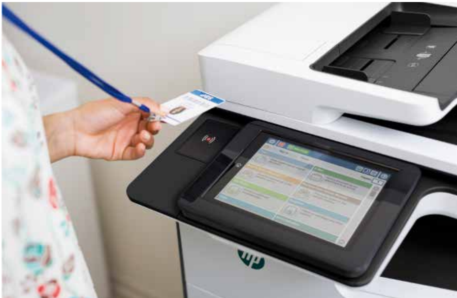
Figura 10.2. Impresora con sistema pull printing . Fuente: HP Inc.
