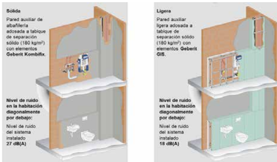
Figura 4.19: Esquema transmisión sonido a nivel estructural. Fuente: Geberit.
