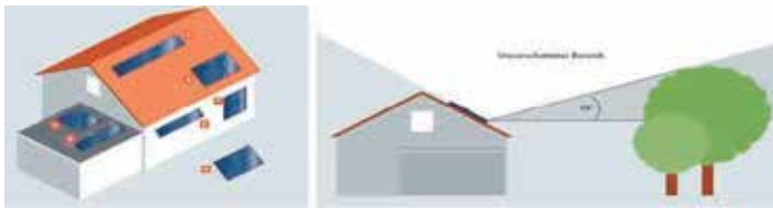
Figura 7.15. Posibilidades de montaje.
