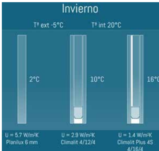
Figura 9.28. Temperaturas superficiales en régimen de invierno.
