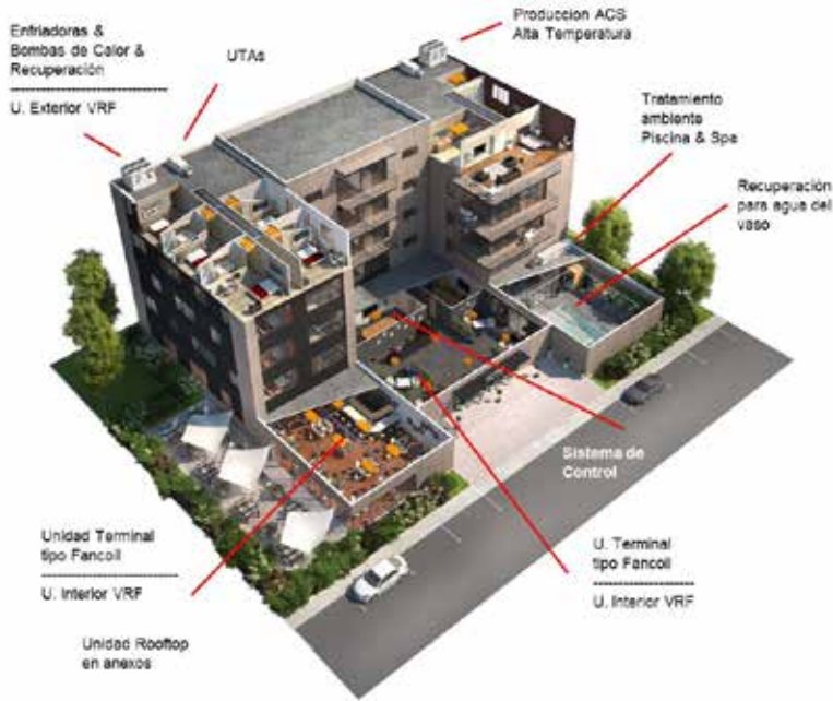
Figura 4.2. Implantación tipo de un Sistema de Climatización.
