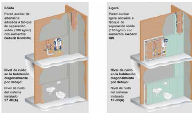
Figura 3.23. Esquema transmisión sonido a nivel estructural.
