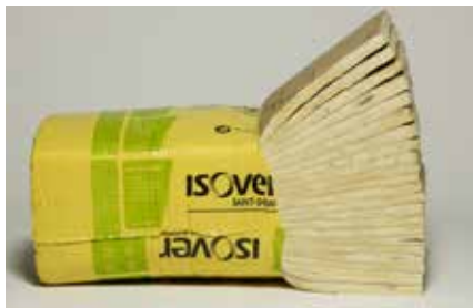
Figura 9.19. Lana de vidrio comercial y su estructura reticular.
