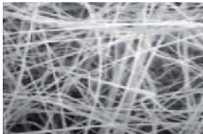
Figura 9.19. Lana de vidrio comercial y su estructura reticular.
