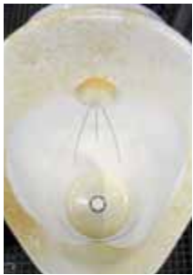
Figura 3.8. Ensayo de funcionamiento del urinario Preda. Ensayo de limpieza del urinario Preda con funcionamiento con 0,5 litros recogido en la norma UNE-EN 13407.
