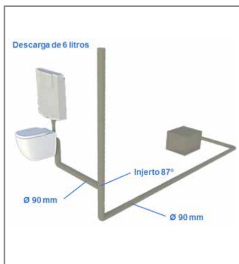
Figura 3.3. Colector con diámetro de 90 mm.
