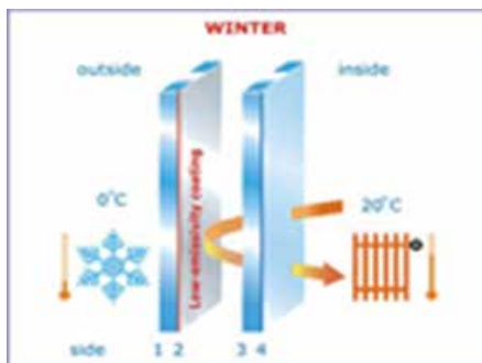
Figura 9.22. Comportamiento de un vidrio de Aislamiento Térmico Reforzado (ATR).
