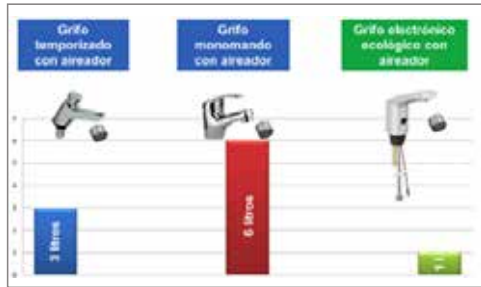
Figura 3.13. Volumen de agua de grifería de lavabo.
