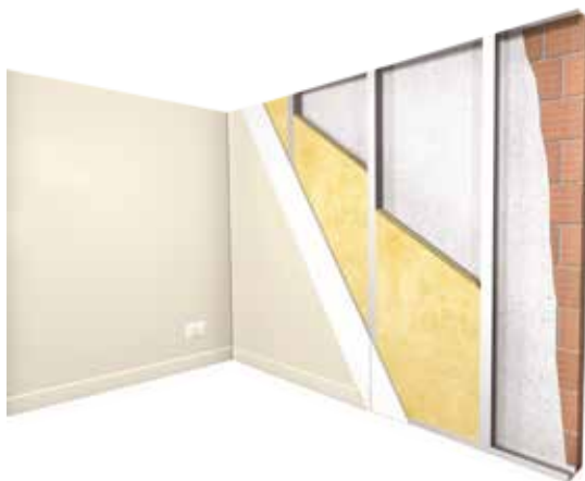
Figura 9.17. Descripción general de un trasdosado.
