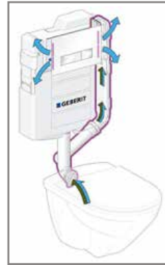
Figura 3.7. Cisterna empotrada con unidad de extracción de olores DuoFresh.
