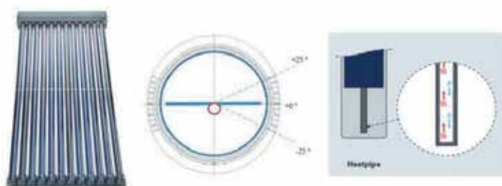
Figura 7.12. Colectores de tubo de vacío (tipo heat pipe).
