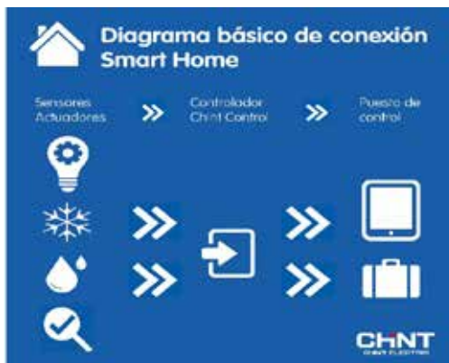
Figura 8.1. Diagrama básico de la conexión del sistema Smart.
