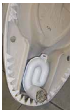
Figura 3.10. Parte trasera de un urinario desmontado de la pared con sifón totalmente obstruido.
