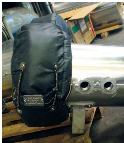
Figura 4.8.1. Ejemplo instalación de colchoneta en brida ciega.
