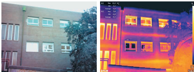
Foto 11.31 y 11.32. Detección cualitativa de mejoras energéticas en la sustitución del conjunto acristalado. Fuente: Isover Saint-Gobain y Fenercom.
