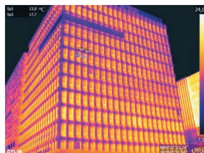
Foto 11.27 y 11.28. La imagen visible no nos aporta mucha información, sin embargo, prestando un poco de atención a la termografía detectamos un vidrio con posibles propiedades diferentes al resto. Esto puede ser debido a una sustitución por rotura. En ocasiones en edificios de oficinas antiguos ya no se disponen de los vidrios originales y ante cualquier rotura se sustituye por uno similar, pero nunca igual como muestra la termografía.
