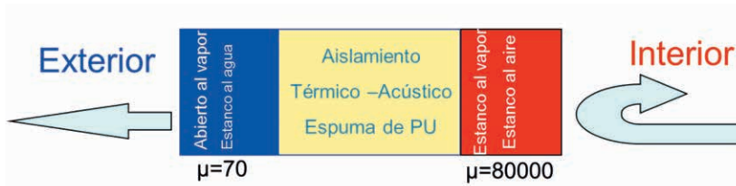
Figura 8.12. Modelo de sellado en 3 capas.
