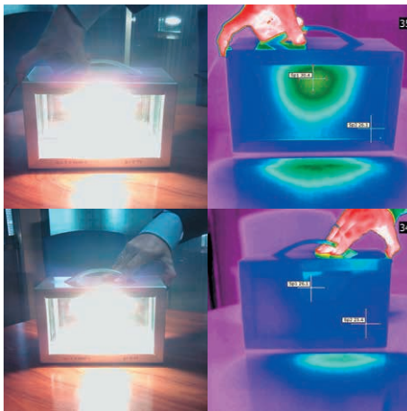
Foto 2.7. Arriba doble acristalamiento tradicional. Abajo SGG CLIMALIT PLUS (Doble acristalamiento ATR). Fuente: SGG CLIMALIT– Saint-Gobain Glass.
