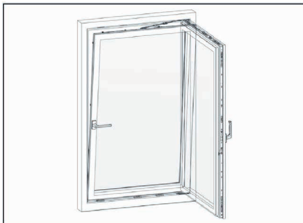
Figura 7.2. Posiciones de la ventana en modo practicable y abatible
