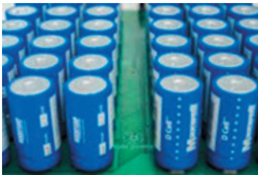
Foto 6. Ultracapacidades. Fuente: Dúplex Elevación.
