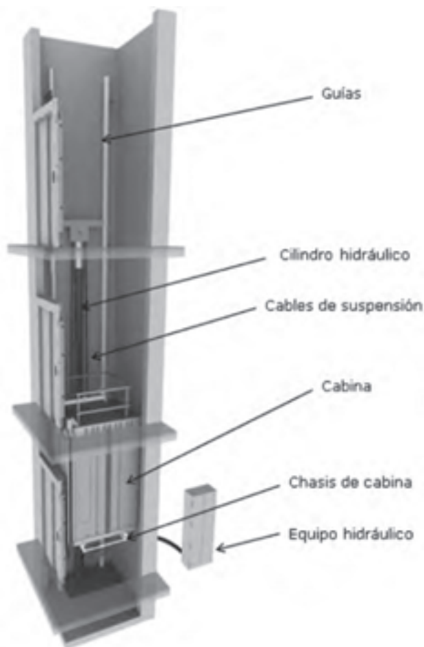
Figura 1. Instalación de un ascensor hidráulico. Fuente: Orona.
