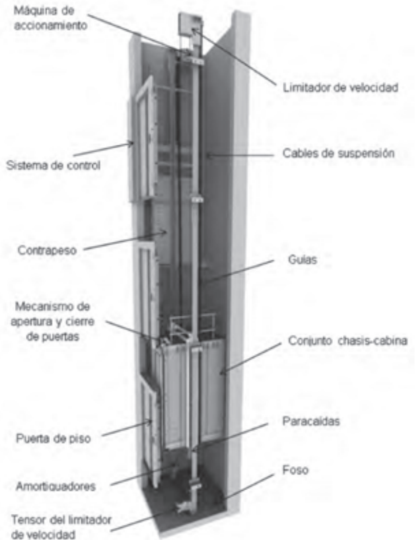
Figura 2. Instalación de un ascensor eléctrico. Fuente: Orona.
