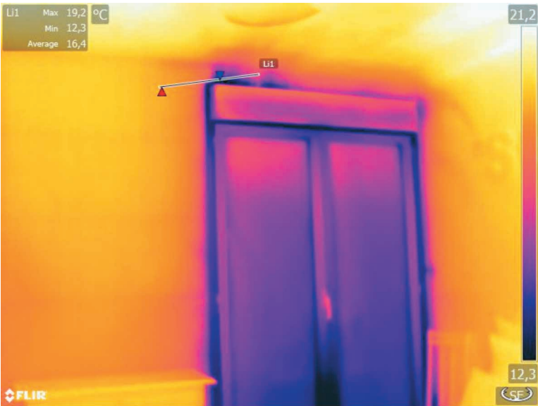
Foto 11.23. Capialzado con entradas de aire en la parte superior
