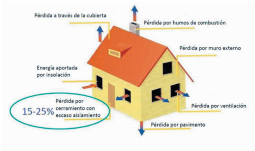
Figura 8.5. Flujos de energía en vivienda unifamiliar.
