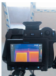
Foto 11.1 y 11.2. Imágenes de una cámara termográfica visualizando una ventana y un test de estanqueidad en desarrollo, ambos en obra nueva.
