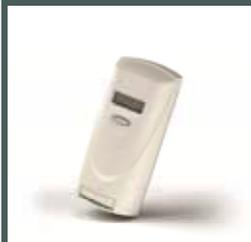
El repartidor de costes de calefacción es un pequeño dispositivo que se instala en los radiadores y que permite evaluar lo que consume cada radiador. Está pensado para ser utilizado en instalaciones con calefacción central por columnas y medir el consumo individual de cada radiador, permitiendo que *cada vecino pague sólo por lo que consume*.
