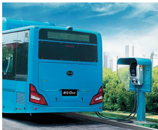
Foto 3. Autobús eléctrico cargando con estándar europeo (modo 3 con conector tipo 2).
