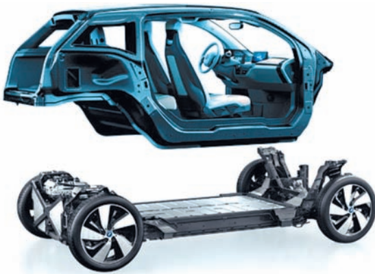
Figura 2. BMW LifeDrive. Chasis de PRFC en el módulo Life y aluminio en el módulo Drive. Esta arquitectura es la base de un producto BMW i.
