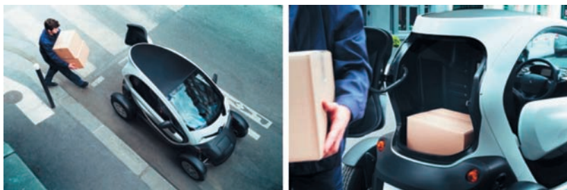
Figura 10. Renault Twiz Cargo: 180 litros con 75 kg de carga.
