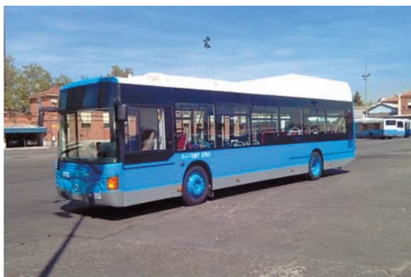
Figura 4. Autobús convencional transformado en híbrido.
