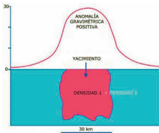
Figura 6.6. Anomalía gravimétrica provocada por un cambio de la densidad de los materiales del subsuelo.
