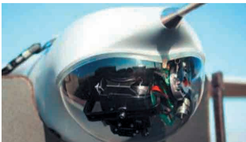
Figura 6.9. Sensor Insitu ScanEagle que integra tres sensores diferentes (John Keller).
