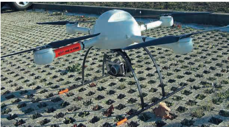
Figura 11.2. Plataforma empleada (Md4-1000) con cámara fotográfica RGB.
