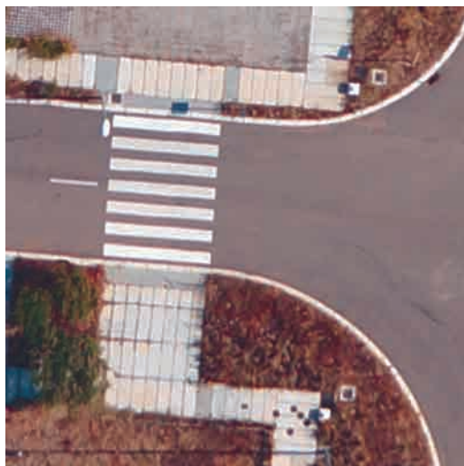
Figura 18.3. Detalle de ortofotografía producida mediante plataforma UAV donde se identifican equipamientos urbanos (Ortofotografía UAV producida por Aerometric Lab, Universidad de Córdoba).
