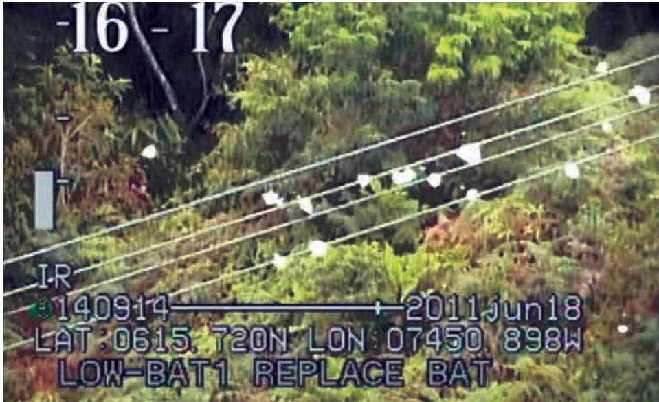
Figura 20.5. Imagen Ultravioleta de los conductores de una línea.
