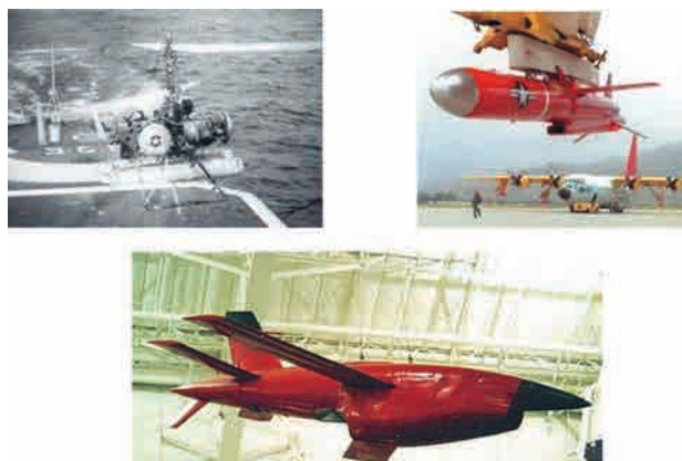
Figura 1.5. Sistemas no tripulados más utilizados durante la Guerra Fría. De izquierda a derecha y de arriba abajo, el UAS VTOL DASH, el Northrop Chukar y el Ryan Firebee.
