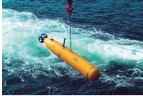
Figura 7.3. Vehículo autónomo submarino propulsado (programa US-GNR).
