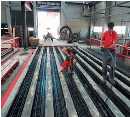
Figura 5.13. Fabricación de pilotes termoactivos en la planta de la empresa que desarrolló esta técnica orientada a la consolidación, mejora e intercambio de energía en terrenos inconsistentes e inundados como son los de la región del Voralberg donde se encuentra NAGELEBAU/ENERCRET, en Rothis. Austria. Fuente NAGELEBAU/ENERCRET/ENERES.
