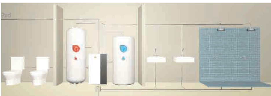
Figura 4b. Esquema de funcionamiento de un sistema de recuperación colectiva de energía de aguas grises. Fuente: Kalhidra.
