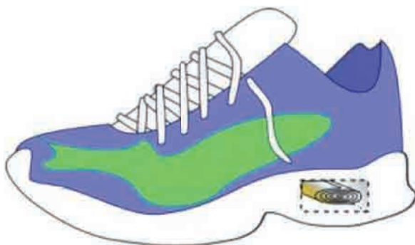
Figura 2. Dispositivo adaptado en la suela de una zapatilla para la recarga de dispositivos electrónicos. Universidad Tecnológica de Luisiana. http://news.latech.edu/2010/04/25/shoe-power-generator-earns-louisiana-tech-professor-national-attention/ .
