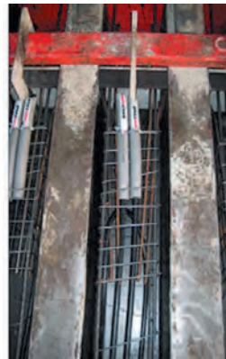
Figura 5.13. Fabricación de pilotes termoactivos en la planta de la empresa que desarrolló esta técnica orientada a la consolidación, mejora e intercambio de energía en terrenos inconsistentes e inundados como son los de la región del Voralberg donde se encuentra NAGELEBAU/ENERCRET, en Rothis. Austria. Fuente NAGELEBAU/ENERCRET/ENERES.
