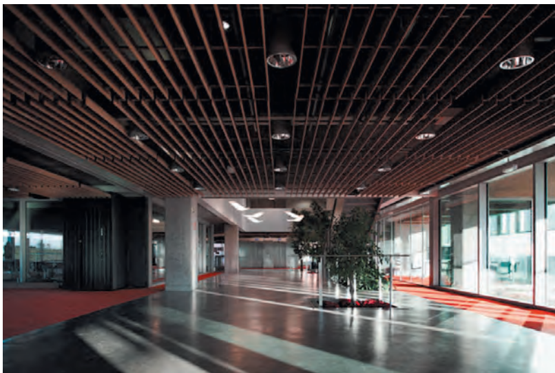
Foto 3.12. Diseño interior de los espacios de la sede de IDOM en Madrid evitando falso suelo y falso techo para aprovechar la masa térmica de los forjados.
