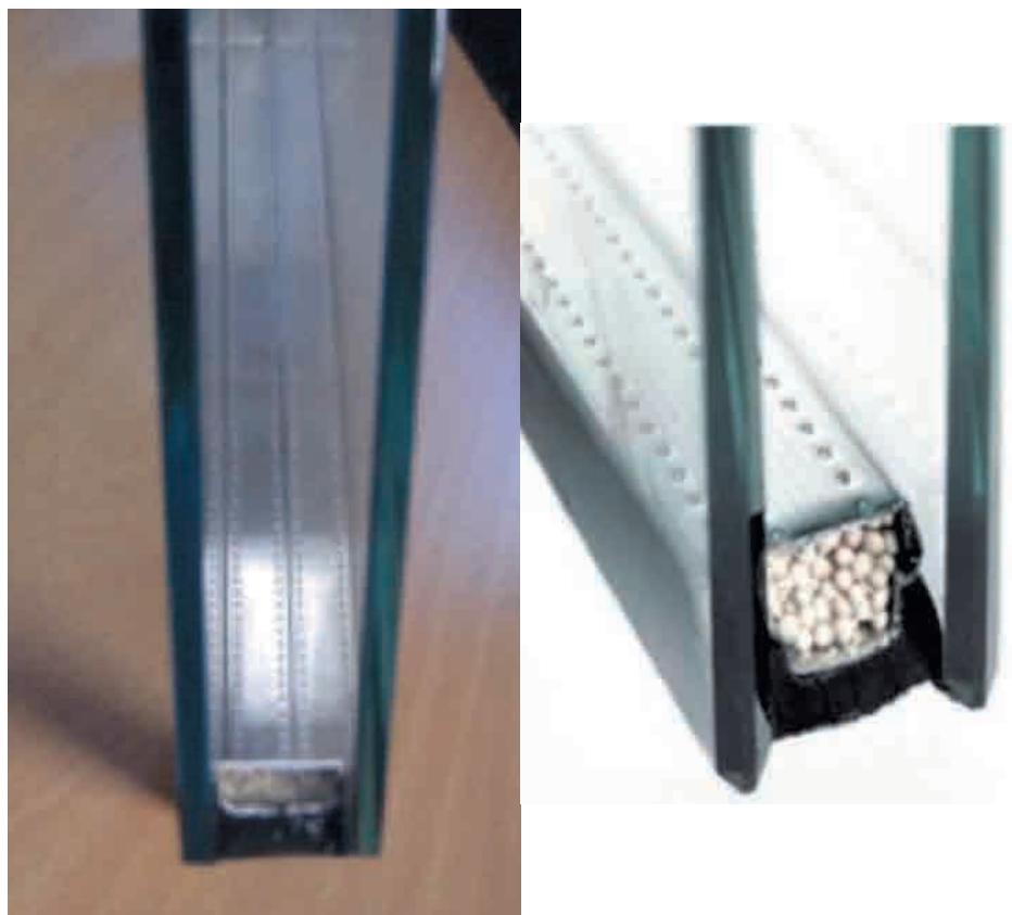
Figura 7.8. Sección de UVA con perfil separador hueco.
