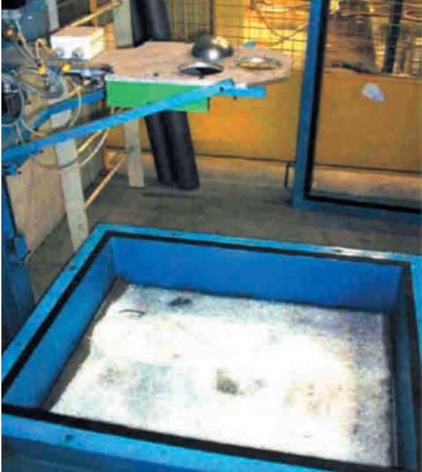
Foto 7.8. Ensayo de caída de bola UNE-EN 356. Fuente: Saint-Gobain Glass.
