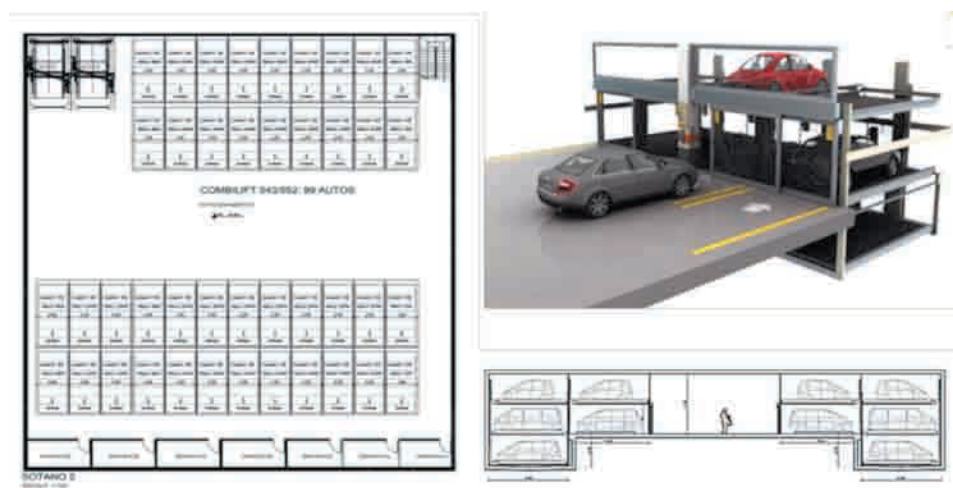
Figura 8.14. Transformación de un sótano en almacén para 111 vehículos con acceso mediante sistemas mecanizados de dos y tres alturas de apilamiento en dos filas, y acceso con dos elevadores de autos en un concesionario de vehículos de importación en Lima, Perú.
