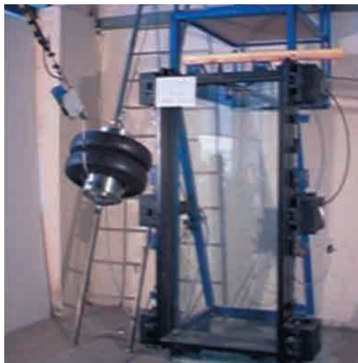
Foto 7.6. Ensayo del péndulo UNE-EN 12600. Fuente: Saint-Gobain Glass.
