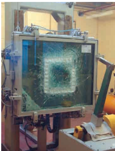
Foto 7.9. Ensayo del hacha UNE-EN 356 (I).
