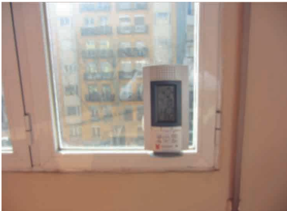
Foto 7.20. Temperatura en un local con acristalamiento UVA básico sin protección solar. T interior 33,2 °C – 20 de julio.
