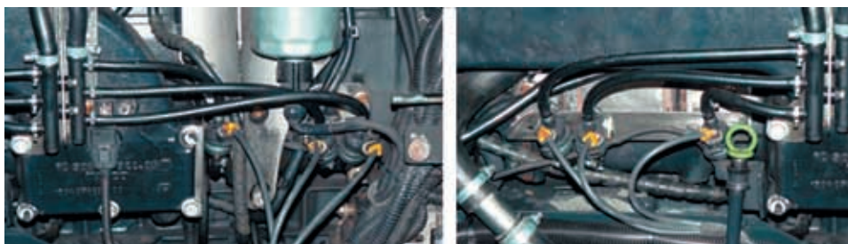
Figura 3.7. Inyectores de gas natural en la culata del motor diésel.
