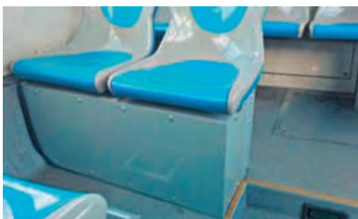
Figura 3.22. Ultracondensador ubicado bajo asientos. Fuente: EMT-AVIA, 2013.
