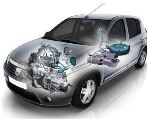
• Esquema sistema GLP. Fuente AEGPL
