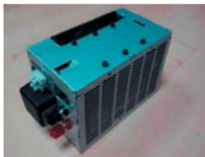
Figura 3.22. Ultracondensador ubicado bajo asientos. Fuente: EMT-AVIA, 2013.
