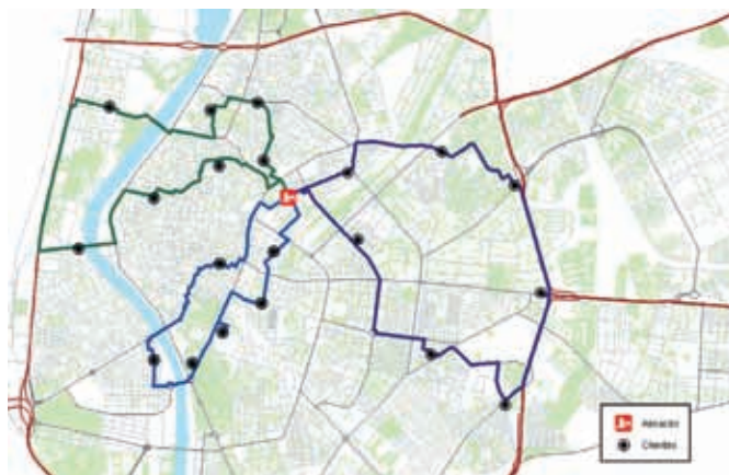
Figura 2.7. Resolución de un problema de Rutas para Flotas de vehículos de suministro desde un almacén a un total de 20 clientes.
