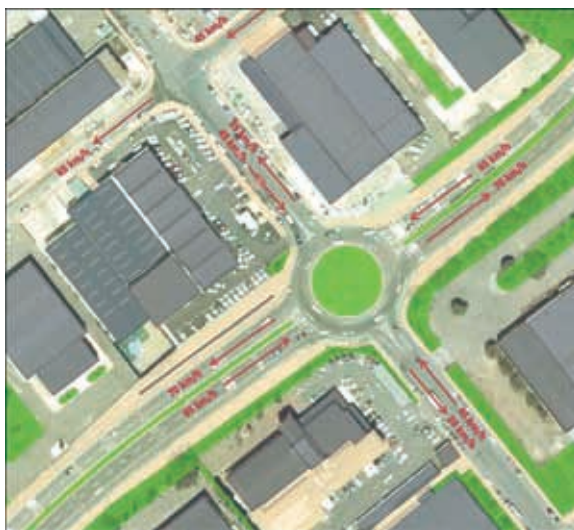
Figura 2.3. Determinación de velocidades de desplazamiento urbano en función de la tipología de vía y elementos reguladores del tráfico presentes en la misma. Fuente: elaboración propia, 2013.
