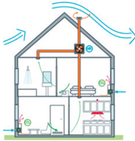
Figura 3.6. Sistema tipo D con admisión descentralizada.
