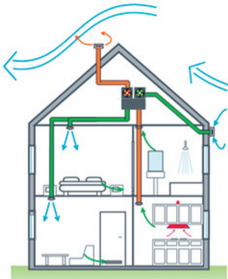
Figura 3.5. Sistema tipo D centralizado.
