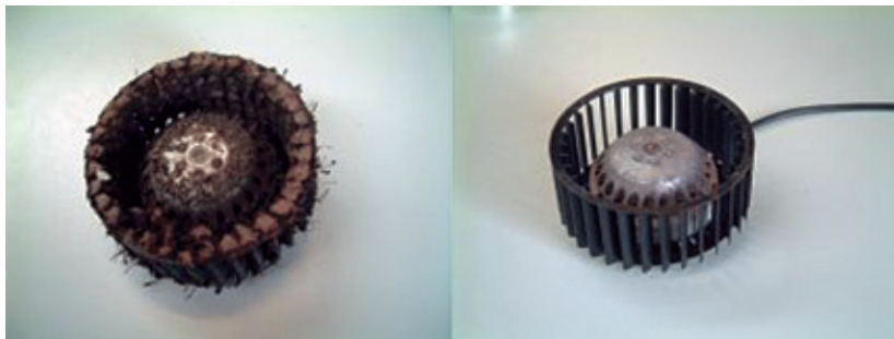
Foto 6.2. Hélice muy sucia (izquierda) y hélice tras limpieza con ultrasonido (derecha).
