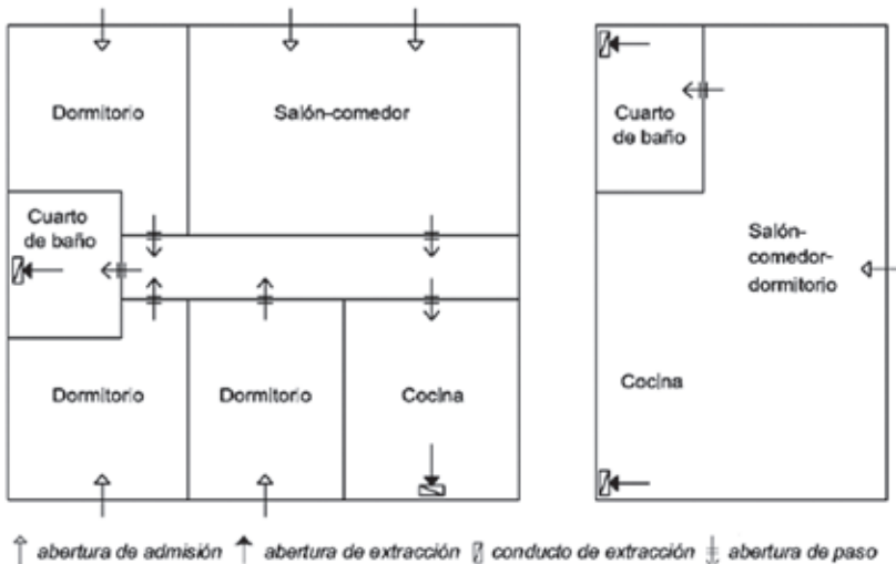
Figura 5.7. Tránsito que debe realizar el aire de ventilación desde las estancias hacia las zonas húmedas.
