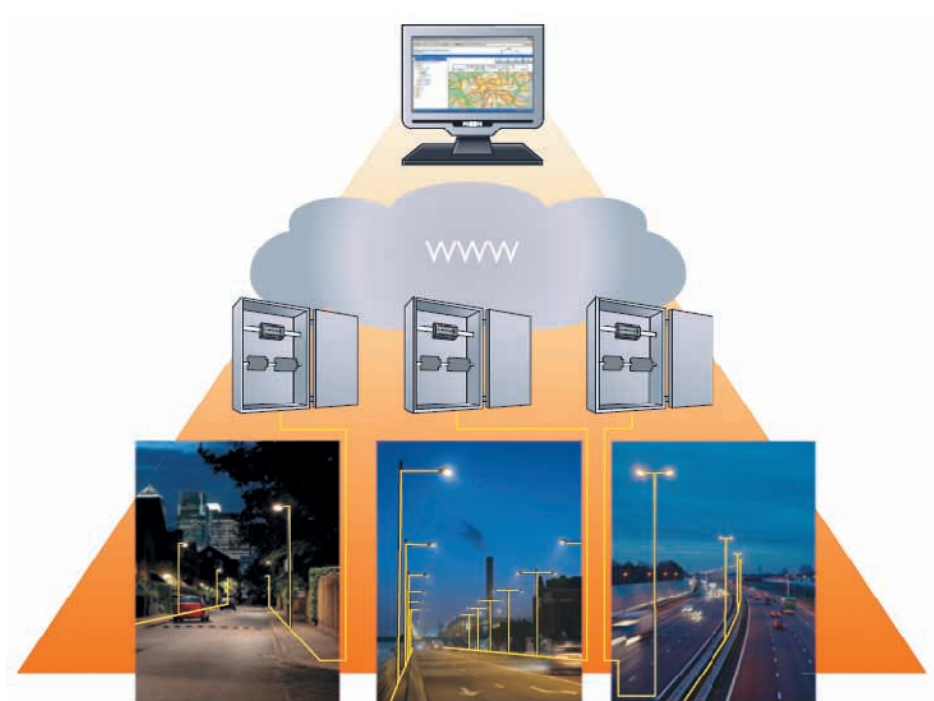
Figura 8. Sistema de telegestión punto a punto Starsense
