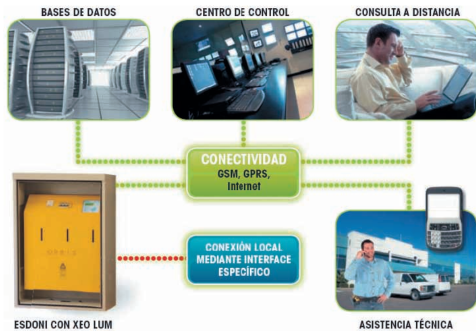
Figura 5. Arquitectura de un sistema de telegestión
