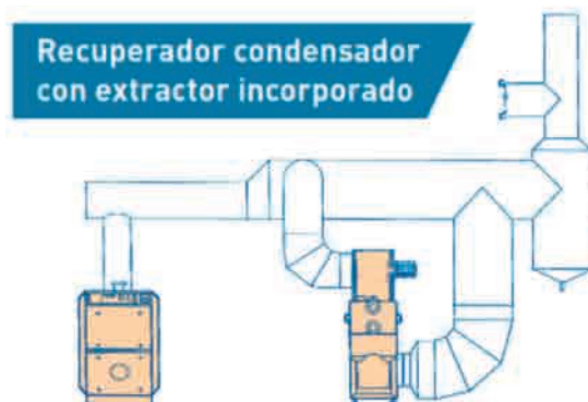
Figura A1.6. Recuperador de humos con extractor (by-pass de humos).
