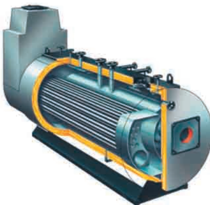
Figura 4.10. Caldera piro-tubular de vapor con economizador incorporado.
