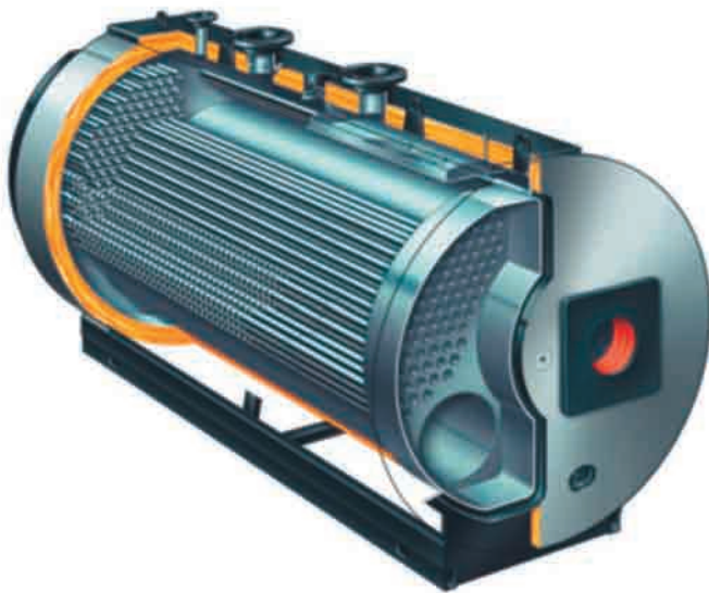
Figura 4.7. Caldera pirotubular de baja temperatura.
