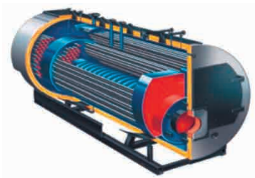
Figura 4.3. Detalle de caldera pirotubular horizontal.
