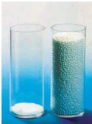
Foto 1: Materia Prima antes y después de la Etapa de Preexpansión. Fuente: ANAPE.
