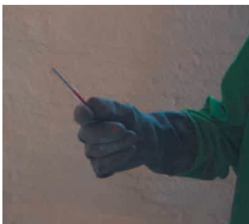
Foto 5. Punzón de no más de 2 mm de diámetro para realizar el ensayo de medición de espesor.
