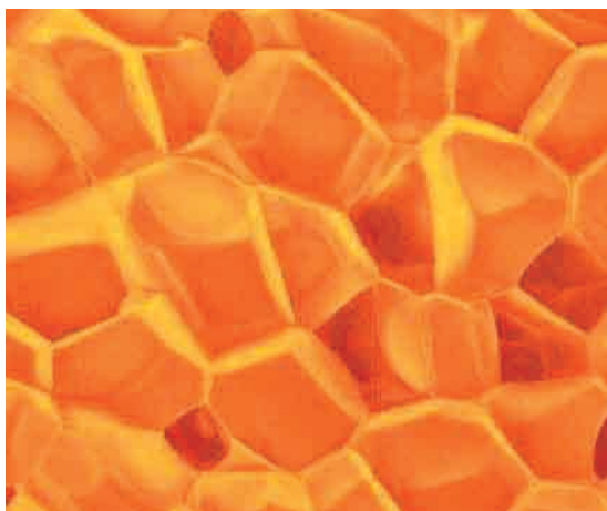
Figura 2. Estructura microscópica del (XPS). Fuente: URSA.
