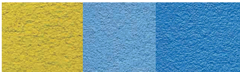
Figura 25. Textura de un revoque rascado. Fuente: Guía IDAE: Sistemas de Aislamiento Térmico por el exterior (SATE) para la Rehabilitación de la Envolvente Térmica de los Edificios.
