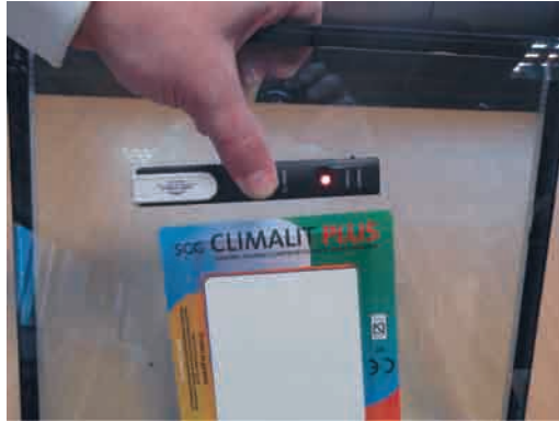
Foto 3. UVA de ATR con capa baja emisiva y detector. Fuente: Fondo fotográfico SGG CLIMALIT PLUS
