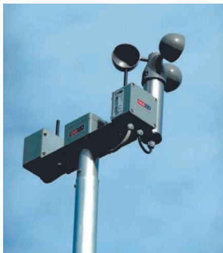
Foto 4. Equipo Concentrador con sensores. Fuente: Samcla
