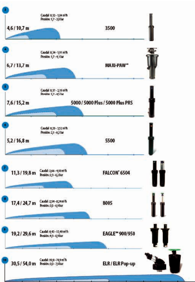
Figura 4. Alcances, caudales y presiones de una serie de aspersores. Fuente: Rainbird
