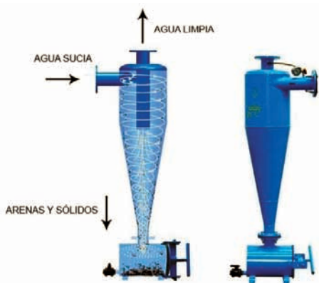
Figura 1. Sistema de filtración de un hidrociclón. Fuente: Jain Irrigation
