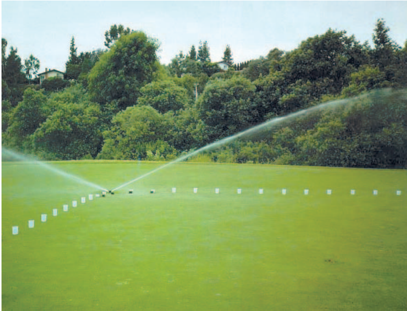
Foto 3. Ensayos en campo de la uniformidad de riego. Fuente: Hunter Industries
