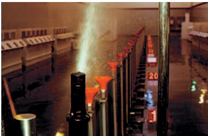
Foto 2. Ensayos en laboratorio de uniformidad de riego de un aspersor. Fuente: Hunter Industries
