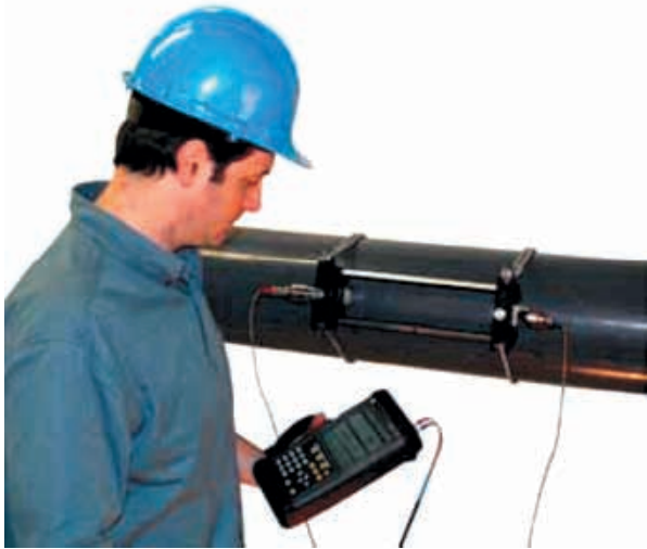
Foto 2. Caudalímetro no intrusivo PT878. Fuente: General Electric
