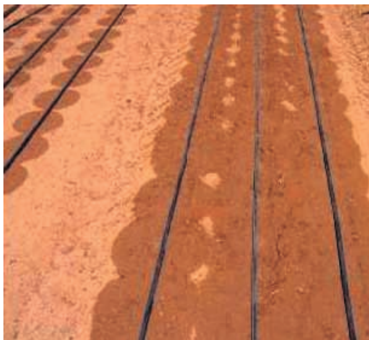
Figura 8. Diferencia de la distribución del agua con gotero de 2,3 l/h y goteo de 0,6 l/h. Fuente: Regaber
