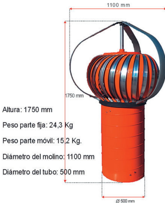
Figura 1. Medidas y pesos del molino extractor eólico. Fuente: Ilustración realizada por F. J. España Moscoso
