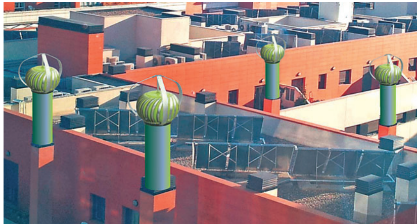
Figura 6. Imagen virtual con extractores eólicos instalados en azoteas. Fuente: F.J. España Moscoso
