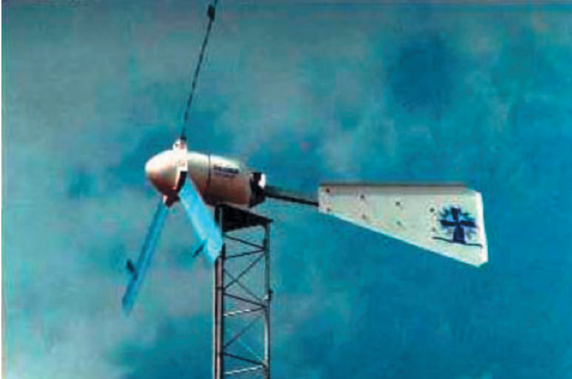
Figura 1. Aerogenerador montado sobre torre de celosía. Fuente: Vélter.
