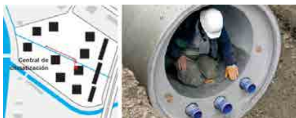
Figura 30. Mapa de la zona: en Línea azul principal de agua residuos, en rojo, bypass con el intercambiador calor Sala de calderas. Fuente: ENERES/KASAG.
