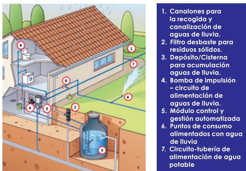
Figura 8. Ejemplo gráfico de una instalación para el aprovechamiento de aguas de lluvia controlada por módulo de automatización.
