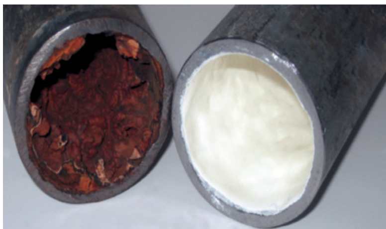
Foto 1. Sección de tubería antes y después del proceso de restauración.
