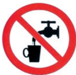
Figura 6. Ejemplo de señalización correcta en equipos y puntos de consumo conectados a redes de aguas grises.
