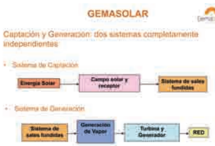
Figura 2. Sistemas de captación y generación en Gemasolar.
