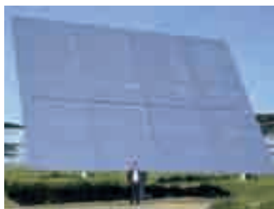
Foto 6. Heliostato Sanlúcar 120, de 28 facetas (4x7).
