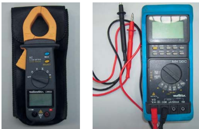
Figura 7.2. Fotografía de pinza amperimétrica (izquierda) y polímetro (derecha).
