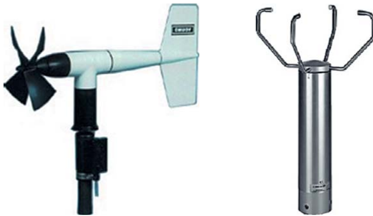
Figura 6.11. Sensores combinados para la medida de la dirección y velocidad del viento.
