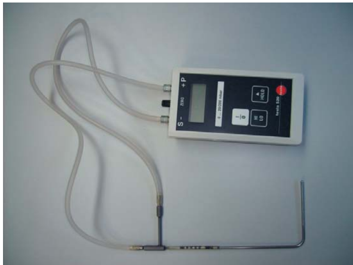
Figura 5.4. Anemómetro de tubo de pitot con micromanómetro.
