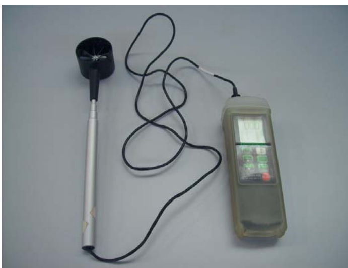
Figura 5.1. Anemómetro mecánico de turbina o de molinete.
