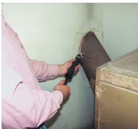
Figura 7.13. Fotografías del funcionamiento de la bomba opacimétrica.
