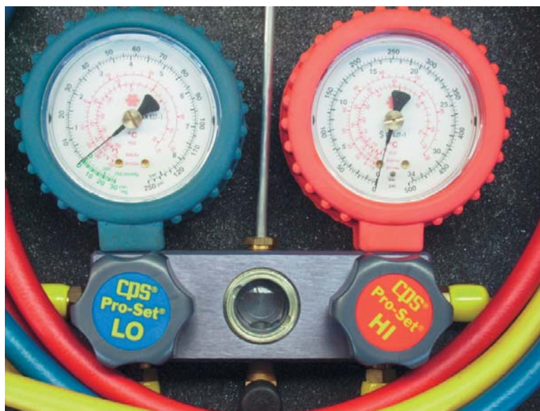
Figura 3.2. Manómetros mecánicos. Puente de manómetros para la medida de las presiones de alta y baja en máquinas frigoríficas.
