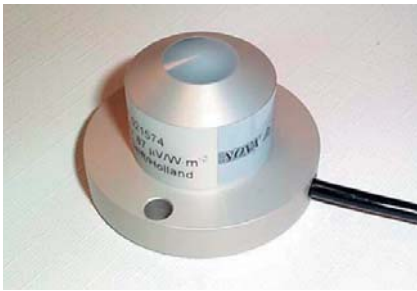
Figura 6.13. Piranómetros de célula de silicio de baja precisión.
