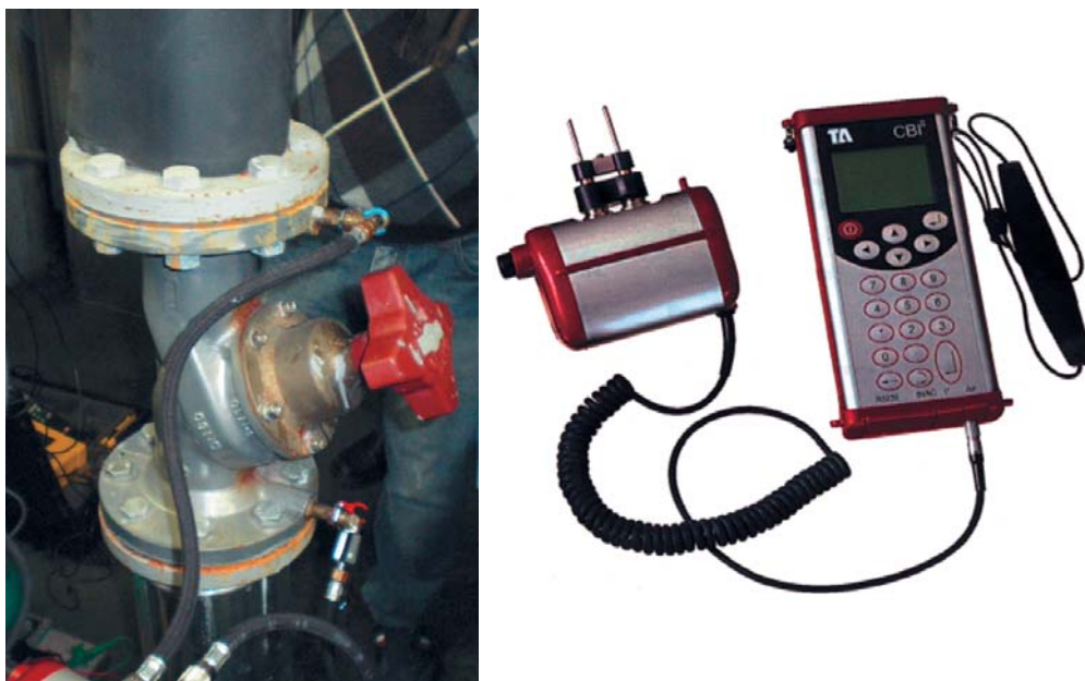
Figura 4.8. Manómetro para la medida del caudal en válvulas de equilibrado.
