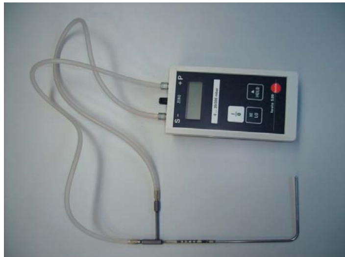
Figura 5.4. Anemómetro de tubo de pitot con micromanómetro.
