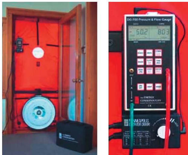
Figura 1. Ejemplo de Blower Door y controlador.
