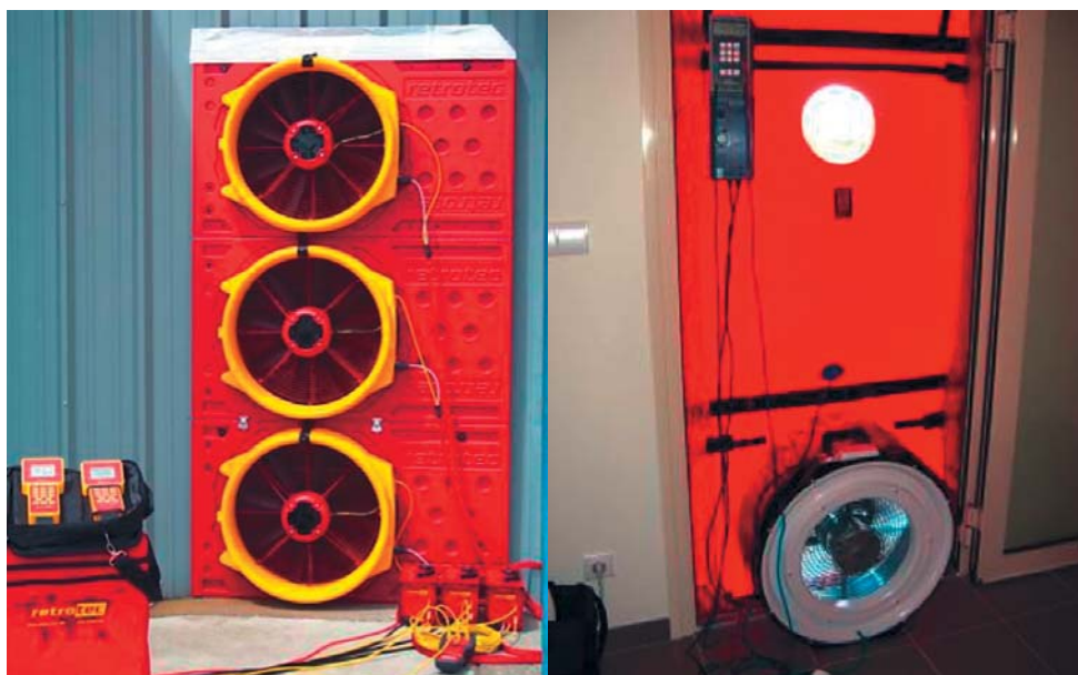
Fotografías 1 y 2. Ejemplos de equipos de infiltrometría manufacturados por los fabricantes más reconocidos.
