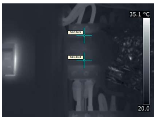
Figura 6. Imagen infrarroja de un automático, papel de aluminio y cinta negra.
