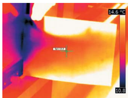
Figura 3. Termograma durante un test Blower Door.
