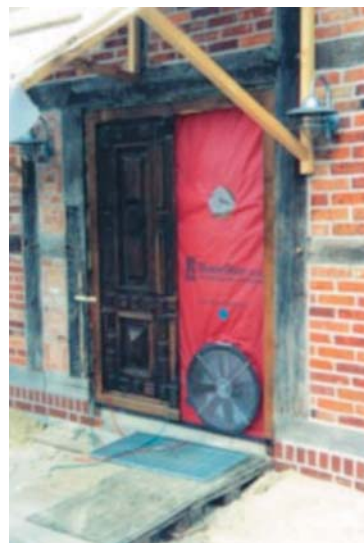
Fotografías 3 y 4. (izq.) Test BlowerDoor en vivienda unifamiliar de nueva construcción. (dcha.) Test BlowerDoor en rehabilitación de edificio con estructura de madera.
