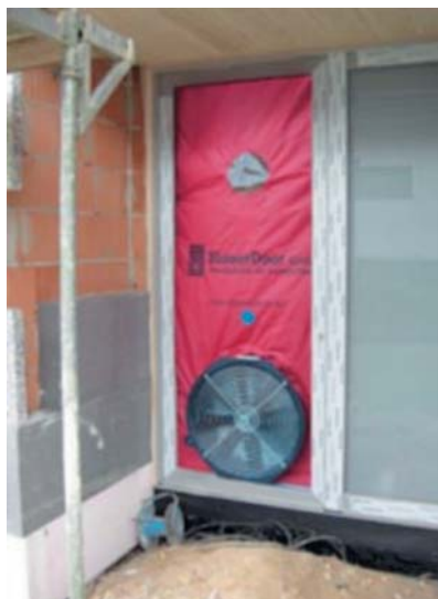
Fotografías 3 y 4. (izq.) Test BlowerDoor en vivienda unifamiliar de nueva construcción. (dcha.) Test BlowerDoor en rehabilitación de edificio con estructura de madera.
