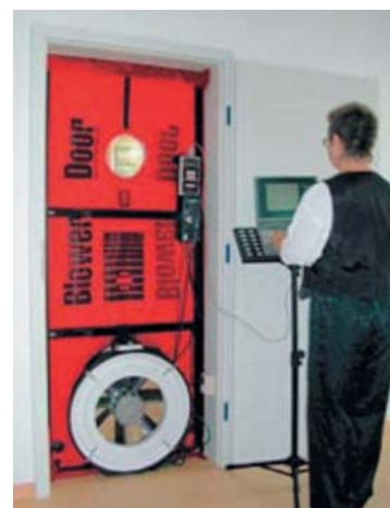
Fotografías 5 y 6. (izq.) El aislamiento es aún visible (planchas y paneles de madera): Este es el momento óptimo para una medición BlowerDoor. (dcha.) Estructura BlowerDoor instalada y lista para la búsqueda de infiltraciones.
