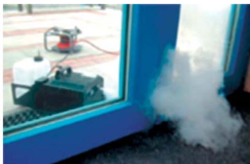
Fotografía 8. Generador de humo.
