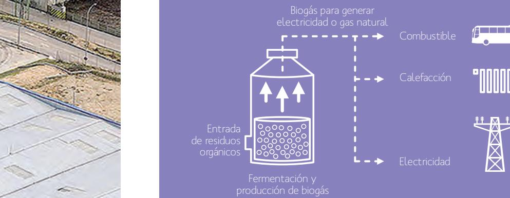
El biogás se recoge y se conduce mediante tuberías a instalaciones de aprovechamiento energético para producir electricidad.
