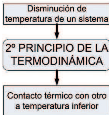
Figura 1. Enfriamiento de un sistema.
