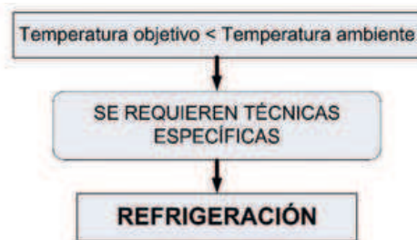
Figura 3. Enfriamiento por debajo de la temperatura ambiental.
