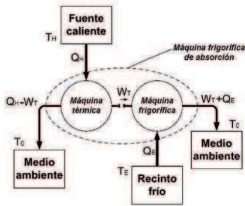
Figura 13. Equivalencia de la máquina de absorción con el acoplamiento de una máquina de compresión mecánica con un motor térmico.
