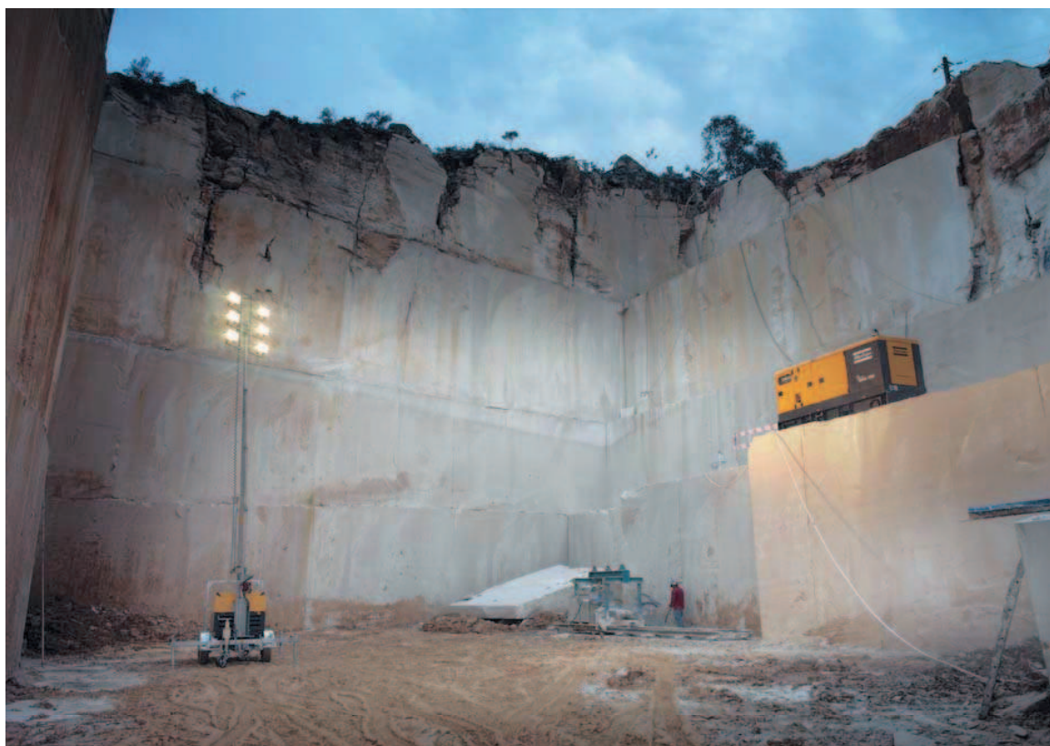
Foto 6.15. Torre de iluminación móvil dotada de generador eléctrico y brazo extensible, en una cantera de caliza ornamental (Portugal) (Fuente: Atlas Copco, S.A.).
