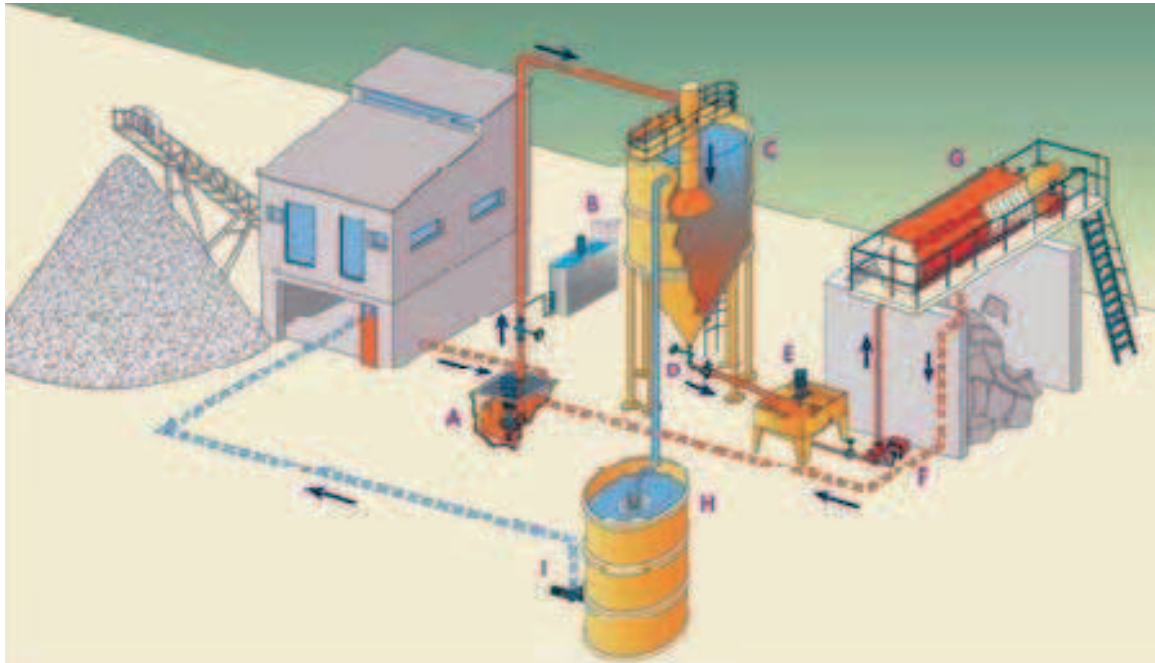
Figura 6.44. Esquema del recorrido del agua empleada en el lavado de arenas, mediante recuperación del agua de proceso (Fuente: Eral).
