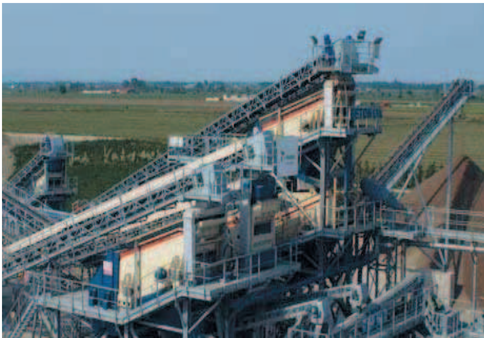
Foto 6.10. Planta de tratamiento secundario: sistema de cintas y cribas (Fuente: Metso Minerals).
