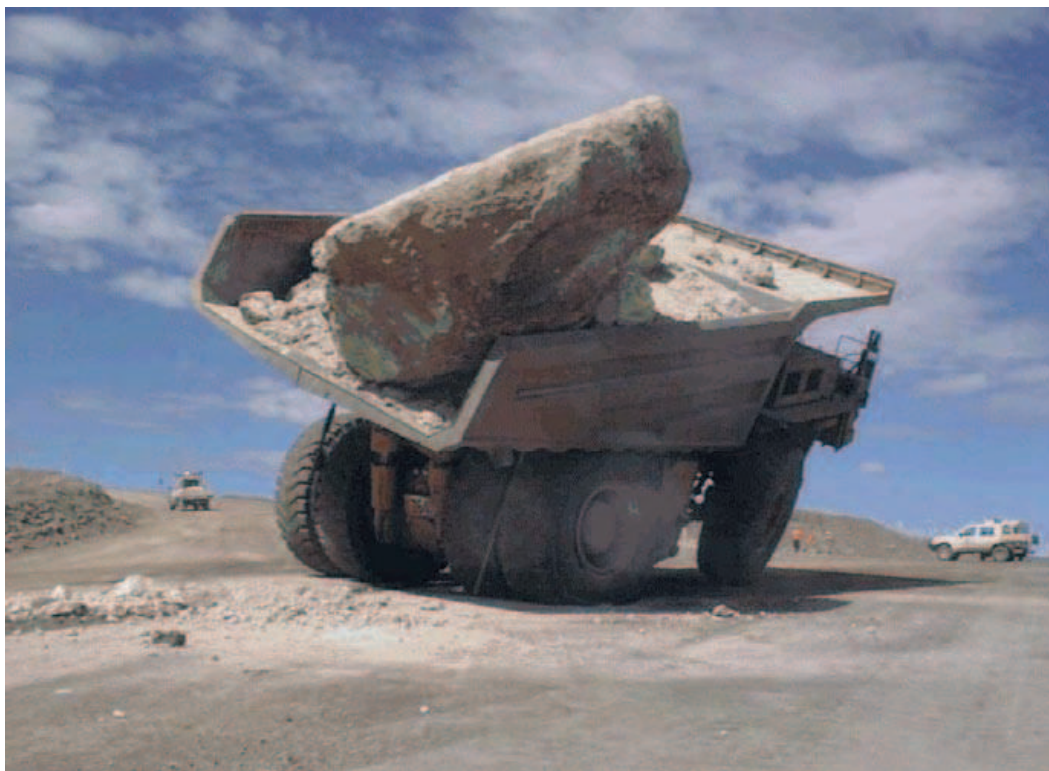
Foto 6.5. Ineficiencia en la operación de transporte debido a una carga excesiva (Fuente: Metso Minerals; 2006).
