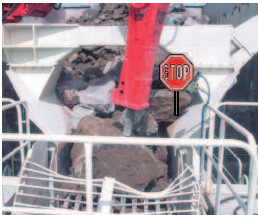
Foto 6.3. Problemas producidos por bolos en la alimentación de la machacadora (Fuente: Metso Minerals).
