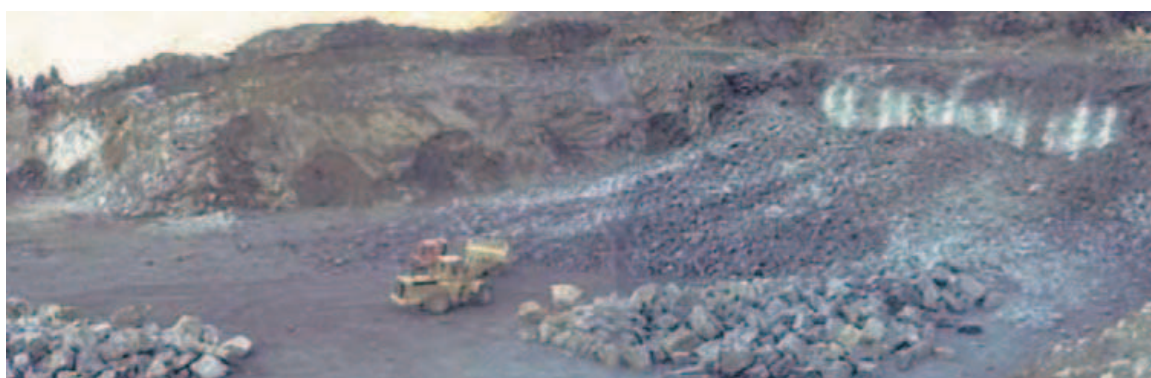
Foto 6.4. Bolos resultantes en una voladura en cantera (Fuente: Metso Minerals y Tamrock studies; 2006).
