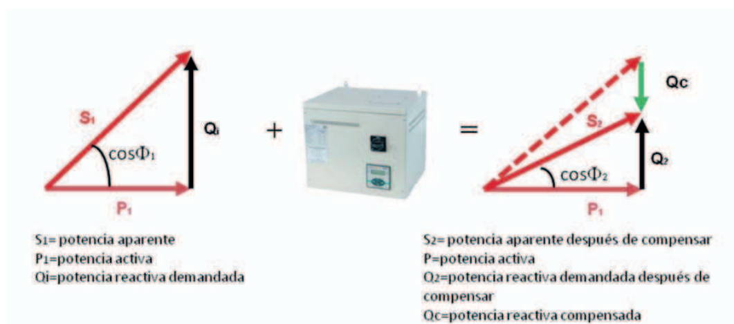
Figura 6.51. Efecto de la instalación de una Batería de Condensadores sobre el triángulo de potencias (Fuente: Montes, P.; 2010).
