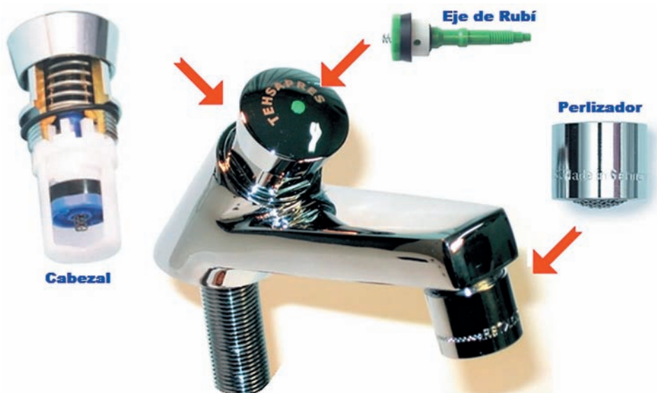
Foto 6. Mejoras posibles en griferías temporizadas: cambio del eje de rubí y del aireador.
