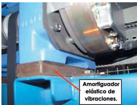
Foto 1. Detalle de apoyo elástico de la máquina sobre la bancada.
