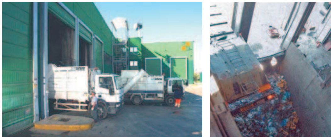
Foto 2.2. Descarga de residuos y foso de recepción. (Fuente: ECODECO y L. Martínez Centeno).
