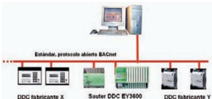
**Figura 8.** Sistema abierto vs. Protocolo de comunicación.
