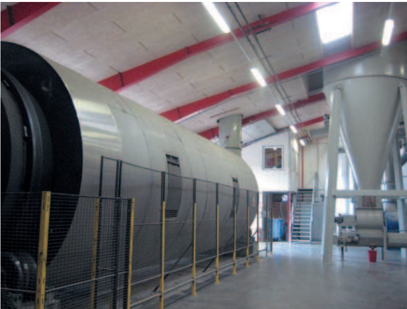
Foto 12. Secadero trommel (izquierda) en una planta de granulación con secadero de trommel. A la derecha se puede ver el ciclón de extracción de producto seco.
