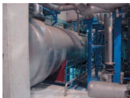
Fotos 9 y 10. Sistema de evaporación a vacío (evaporador y condensadores en la foto 9 de la izquierda; calentador de tubos en la foto 10 de la derecha) en planta de tratamiento de purines.
