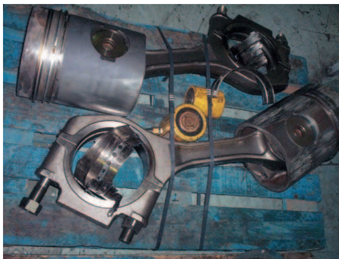
Foto 1. Conjuntos pistón-biela, durante una reparación. El pistón inferior presenta marcas de gripado muy acusadas. La avería produjo además la rotura de cojinetes. Fuente: Archivo Renovetec.
