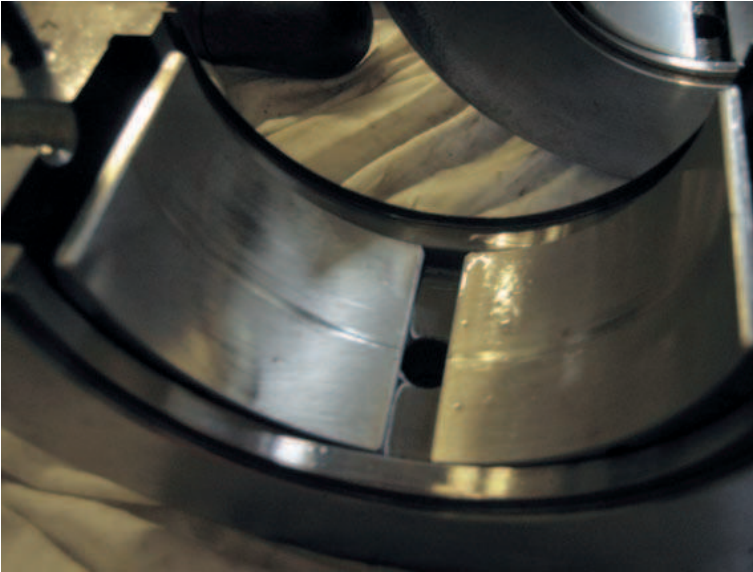
Foto 7. Cojinete radial con marcas y arañazos. Fuente: Archivo Renovetec.
