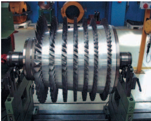
Foto 4. Compresor de una turbina aeroderivada durante una reparación. Fuente: Archivo Renovetec.
