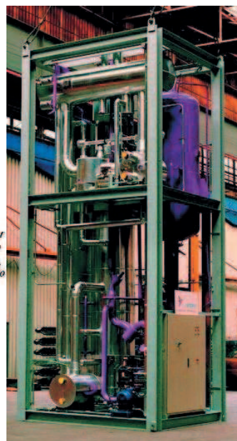
Figura 18. Esquema de flujo de una máquina de absorción de amoníaco y vista del módulo principal. Cortesía Colibrí.
