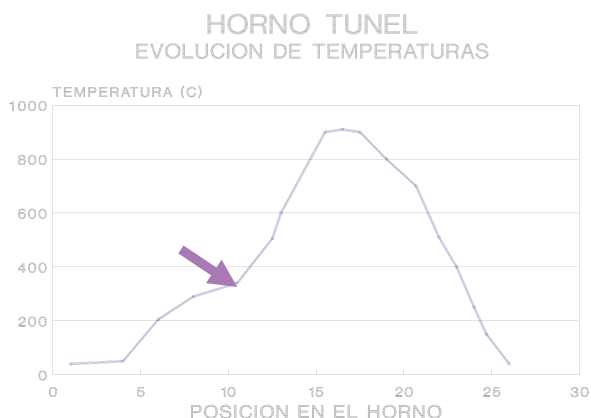
Figura 15. Evolución de temperaturas a lo largo de un horno túnel para la fabricación de ladrillo.
