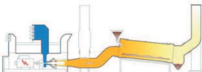
Figura 8. Generación de potencia eléctrica con aprovechamiento de gases calientes para secar biomasa.
