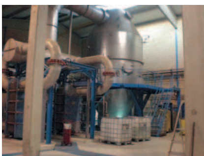
Fotos 9 y 10. Sistema de evaporación a vacío (evaporador y condensadores en la foto 9 de la izquierda; calentador de tubos en la foto 10 de la derecha) en planta de tratamiento de purines.
