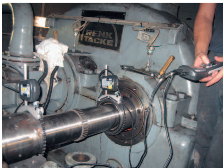
Foto 6. Alineación de una turbina de vapor. Fuente: Curso Renovetec de turbinas de vapor.
