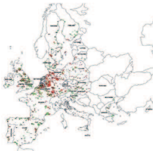
Figura 3. Visualización de los consumos de calor susceptibles de ser cubiertos por cogeneración para plantas de gran tamaño en el sector químico, alimentario, papel y refino. En verde, plantas de cogeneración que ya cubren estos consumos. En rojo, potencial cubierto por tecnologías convencionales.
