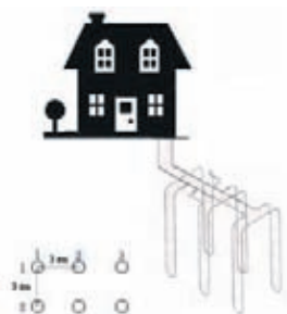
Figura 9. Esquema de configuración en "boreholes". Fuente (GEOCOOL).
