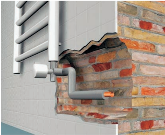
Figura 7. Esquema de una tubería con aislamiento térmico.
