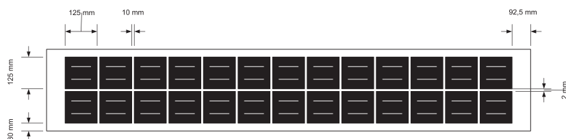
Figura 11. Ejemplo de lama de 312 mm de ancho con células de 125x125 mm.
