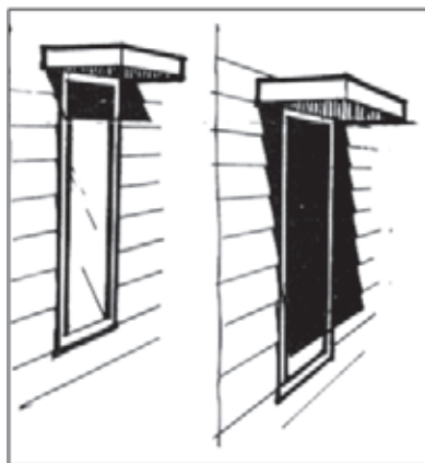
Figura 4. Favorece las ganancias térmicas en invierno (izq.) y las reduce en verano (dcha.)
