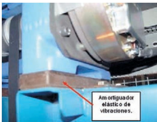
Figura 13. Detalle de apoyo elástico de la máquina sobre la bancada.
