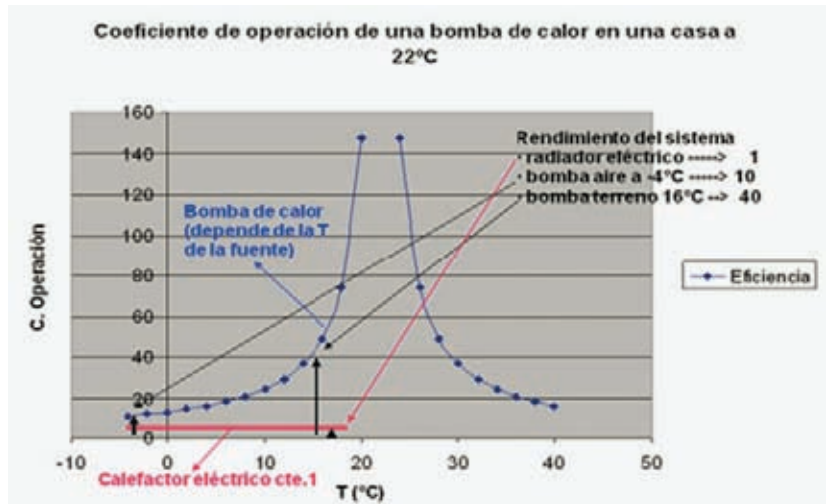
Figura 7. Eficiencia teórica de una bomba de calor en función del salto térmico.
