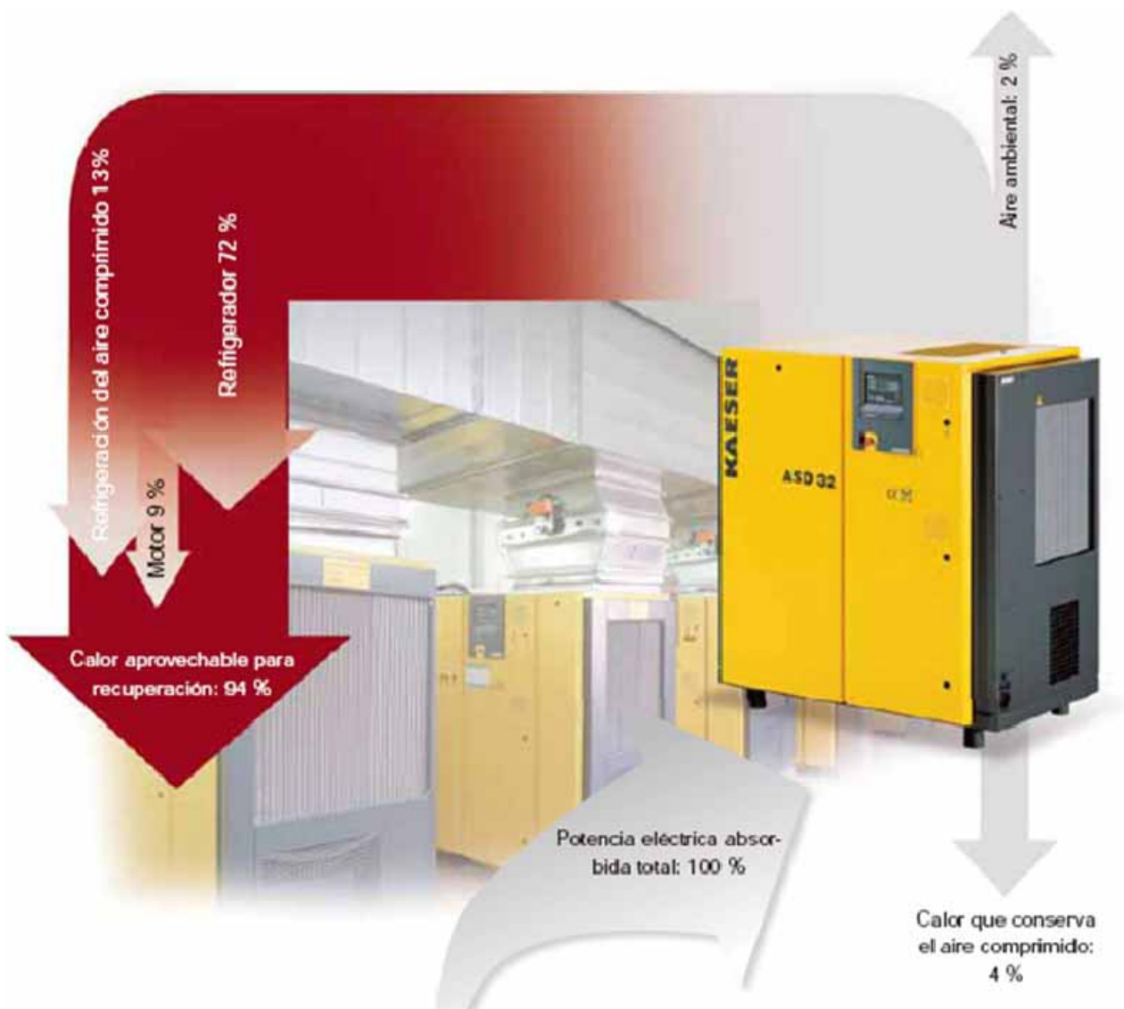
Figura 2. Flujos térmicos en un compresor de aire (Fuente: Kaeser).
