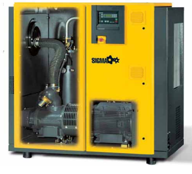
Foto 1. Sistema de compresor helicoidal con transmisión síncrona y control con sistema PLC.
