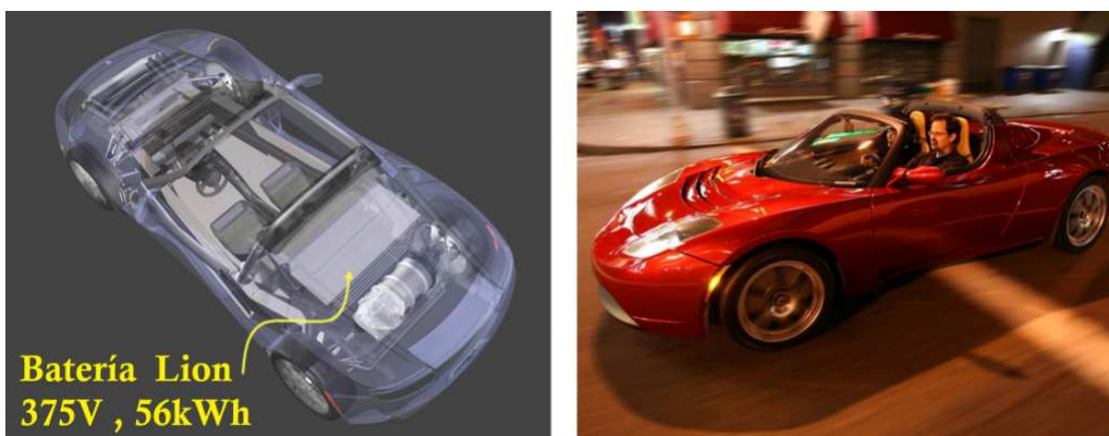
Foto 6.3. Esquema y fotografía del Tesla Roadster, vehículo eléctrico impulsado por baterías de ión-litio.
