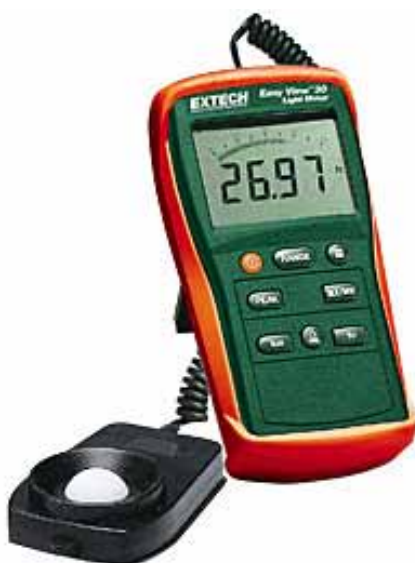
Foto 6.4. Luxómetro (Fuente: Extech).
