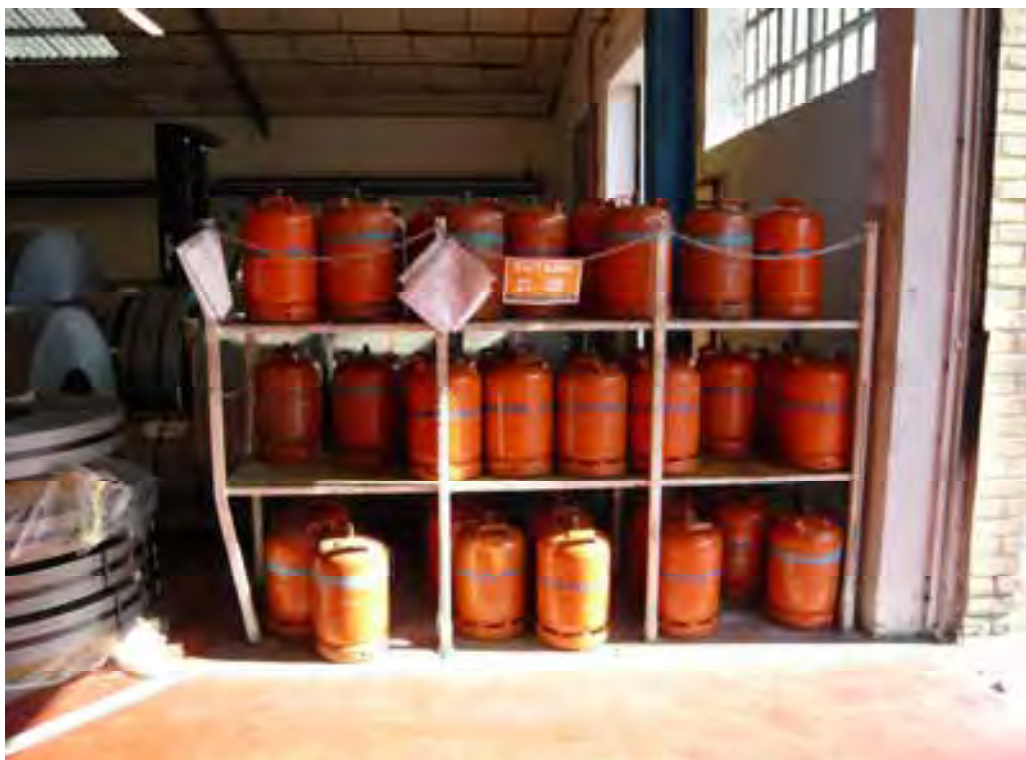
Foto 7.6. Almacenamiento de bombonas de gas butano.
