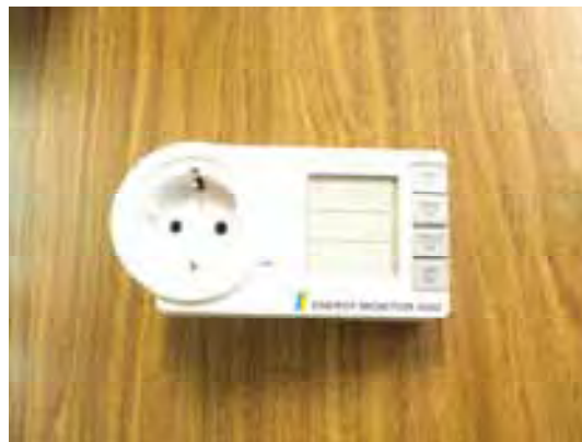
Foto 5.7. Medidor de energía eléctrica.
