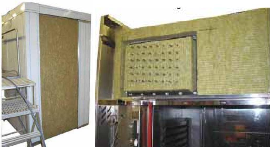
**Figura 2.** Aislamiento de la cara posterior y aislamiento frontal.
