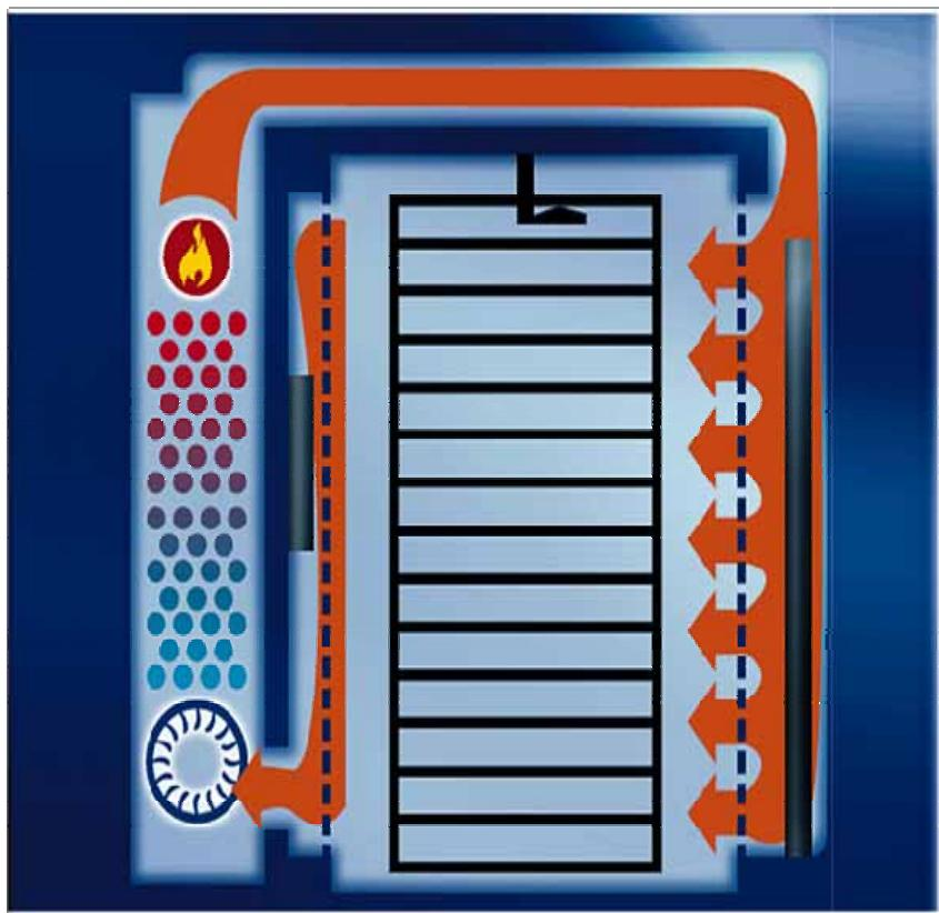
Figura 11. Intercambio de calor.
