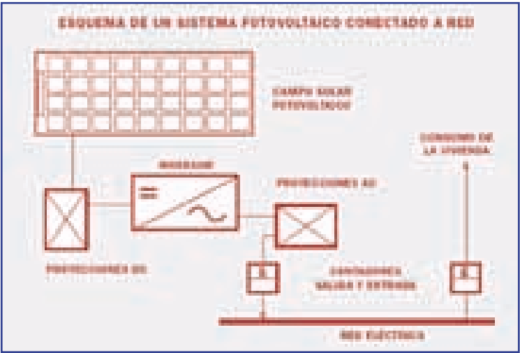
Figura 4. Instalación conectada a la red.
