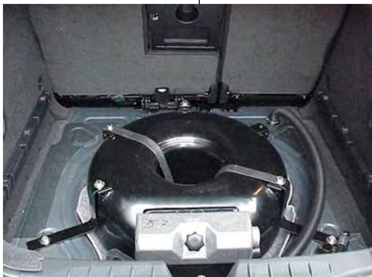
Foto 6.3. Depósito de GLP integrado en el maletero de un vehículo, SEAT.
