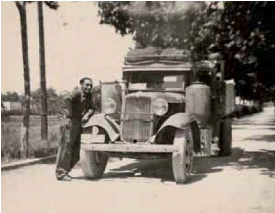
Foto 6.2. Durante la posguerra la falta de gasolina obligó a buscar soluciones imaginativas para hacer funcionar los vehículos. Camión con gasógeno.
