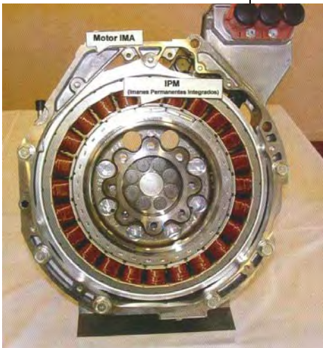
Figura 5.6. Motor propulsor/generador con imanes permanentes integrados de un tren motor híbrido de Honda.
