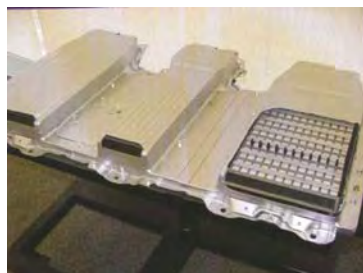
Foto 5.6. Batería de Ni-MH preparada para alojarse en el asiento de un vehículo Toyota.
