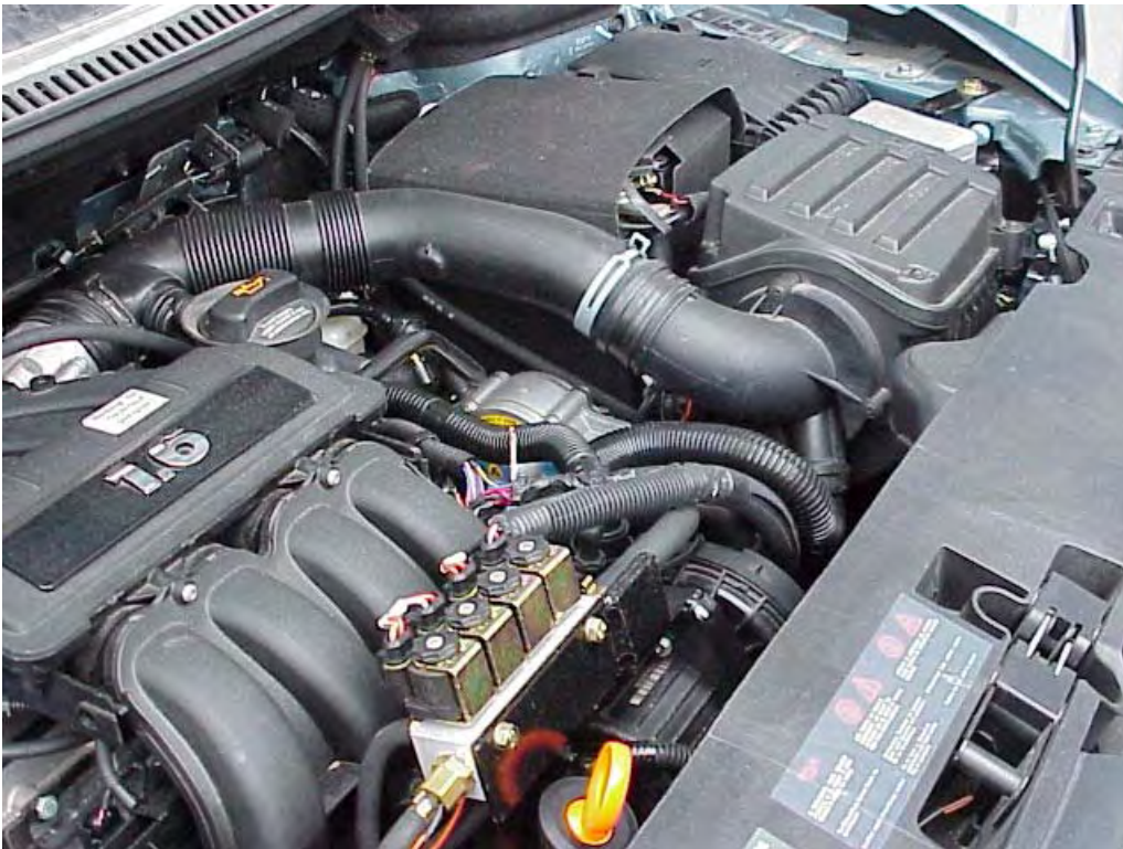
Foto 6.4. Conjunto inyectores, evaporador y centralita electrónica de un vehículo transformado en origen.
