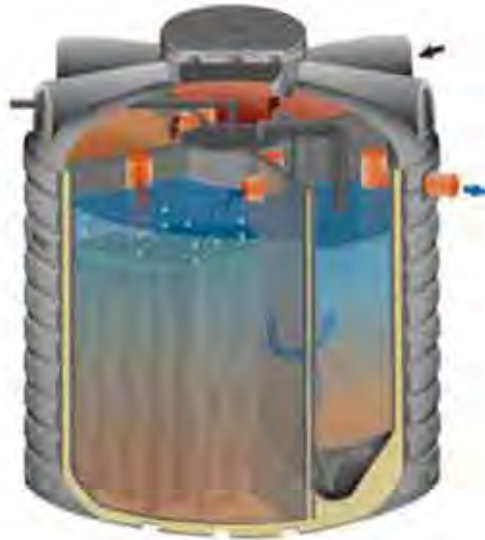
Figura 4. Reactor SBR Istobal. Semisección.
