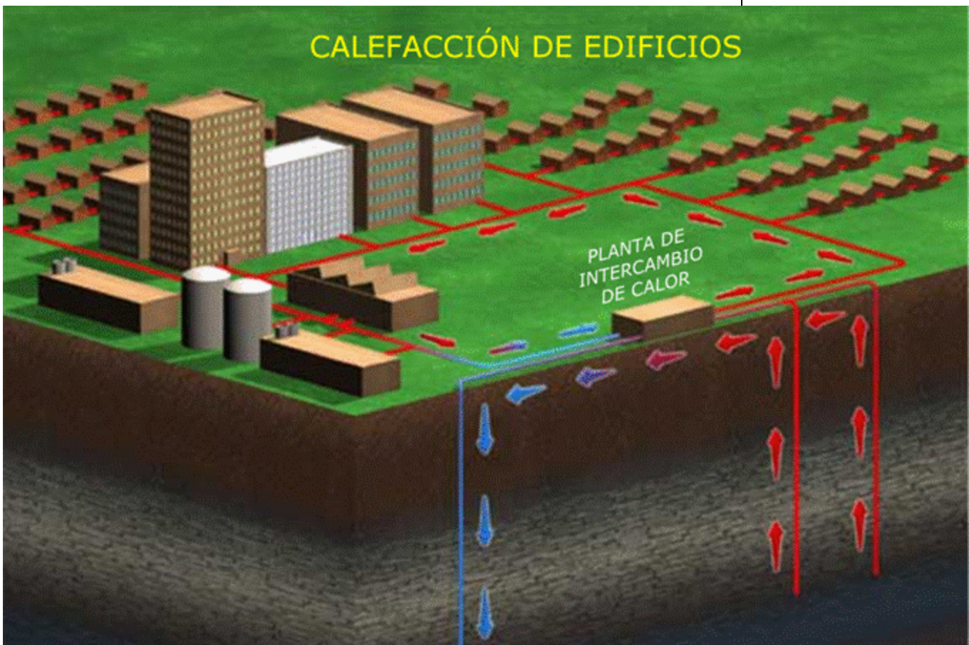
Figura 5.5. Agua geotérmica bombeada desde dos pozos de alimentación a la planta de intercambio de calor. Desde ésta, el circuito secundario abastece a un conjunto de edificios. (Fuente: @2000 Geothermal Education Office).
