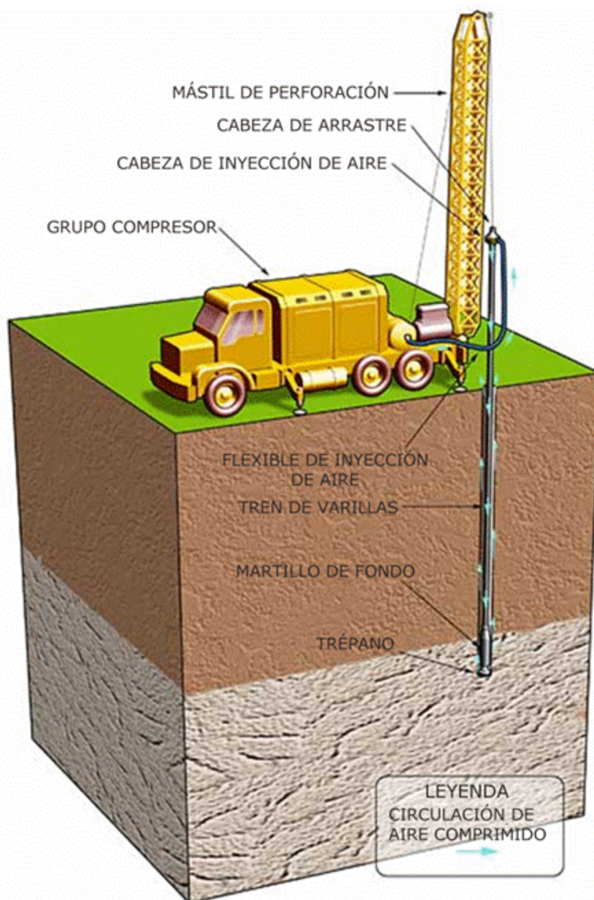
Figura 5.2. Perforación a rotopercusión con martillo en fondo. (Fuente: Site Geothermie-Perspectives de l'ADEME et du BRGM).
