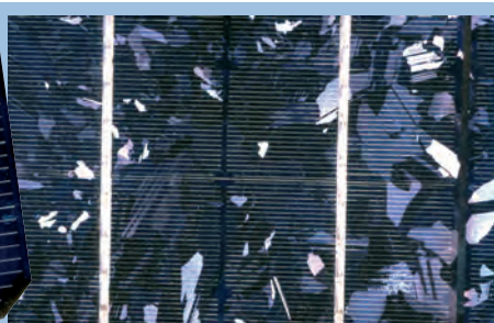
Los distintos tonos de los cristales de silicio son perfectamente visibles en las células policristalinas, que se distinguen bien de las monocristalinas, a la izquierda.
